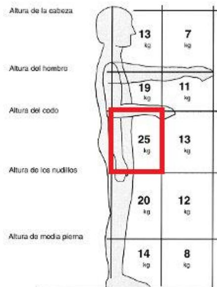
Figura 5.1.1: Esquema de los pesos según posición de agarre
