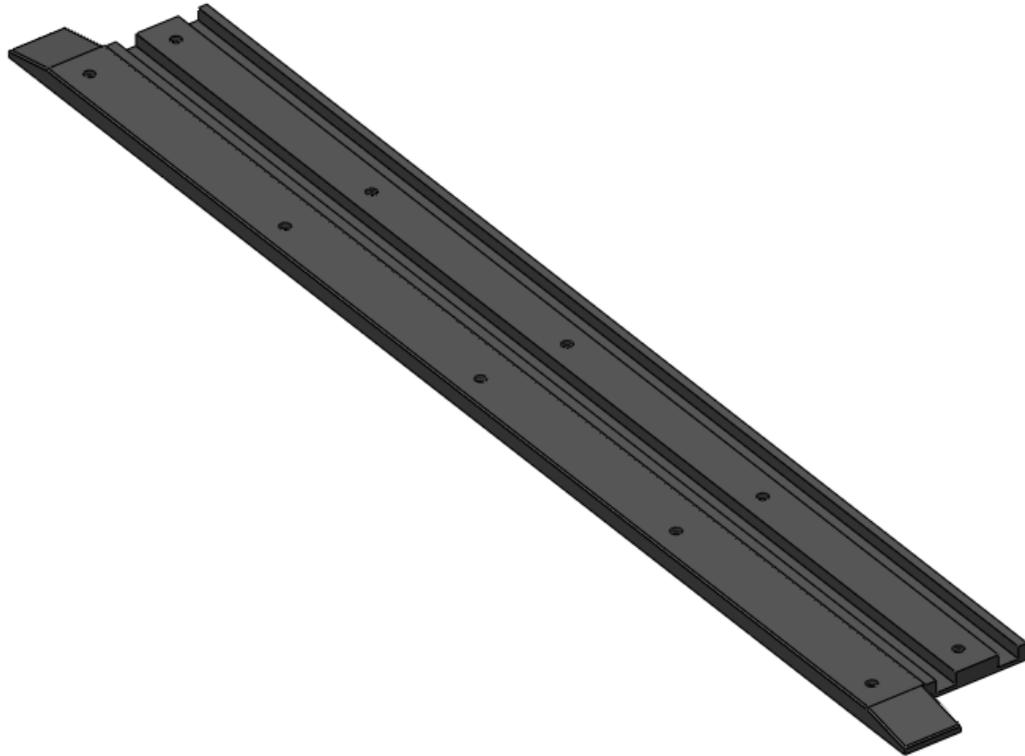
Figura 4.3.4.9: Esquema de uno de los apoyos de la cama de desgaste
