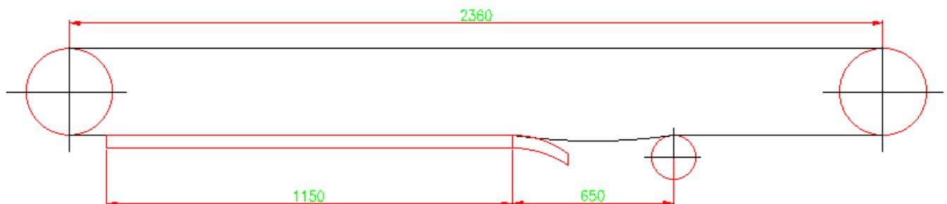
Figura 4.3.6.2: Esquema básico de dimensiones de cintas para el cálculo
