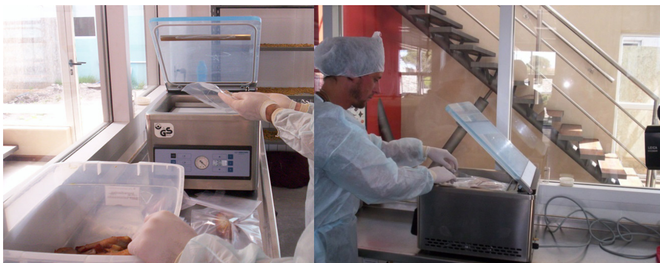
Figura 9: Proceso de envasado de los filetes de trucha y tilapia.
