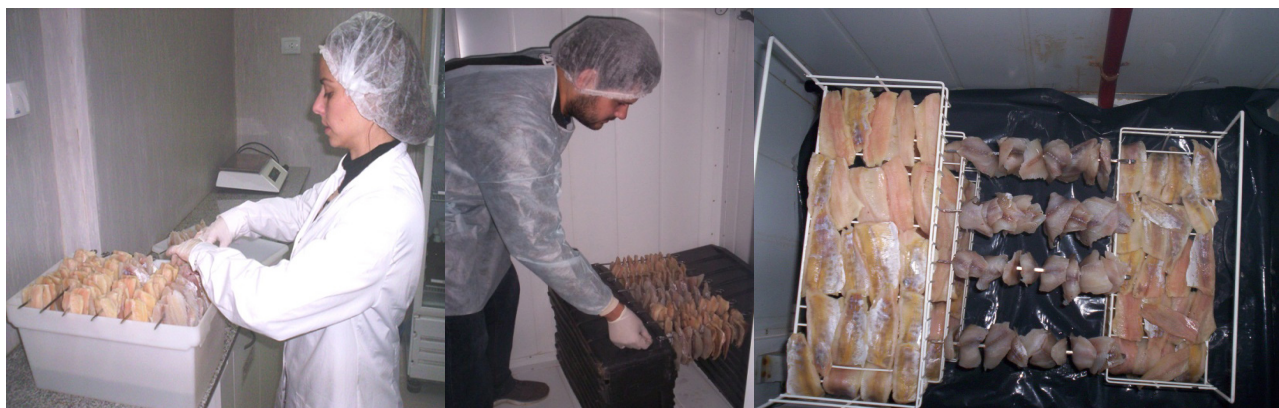
Figura 3: Oreado de filetes en pinchos y bandejas enrejadas de acero inoxidable.
