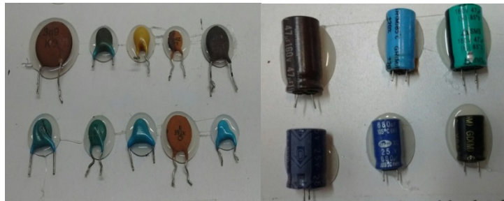
Figura 2: Imágenes de capacitores.
