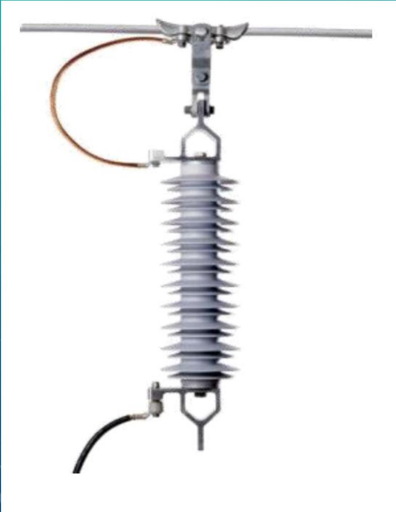
La línea no utilizara hilos de guardia, pero debemos asegurarnos una protección ante sobretensiones. Para esto es posible utilizar descargadores, ubicándolos cada 450 metros en la fase superior y en las 2 fases restantes cada 1350 metros.
