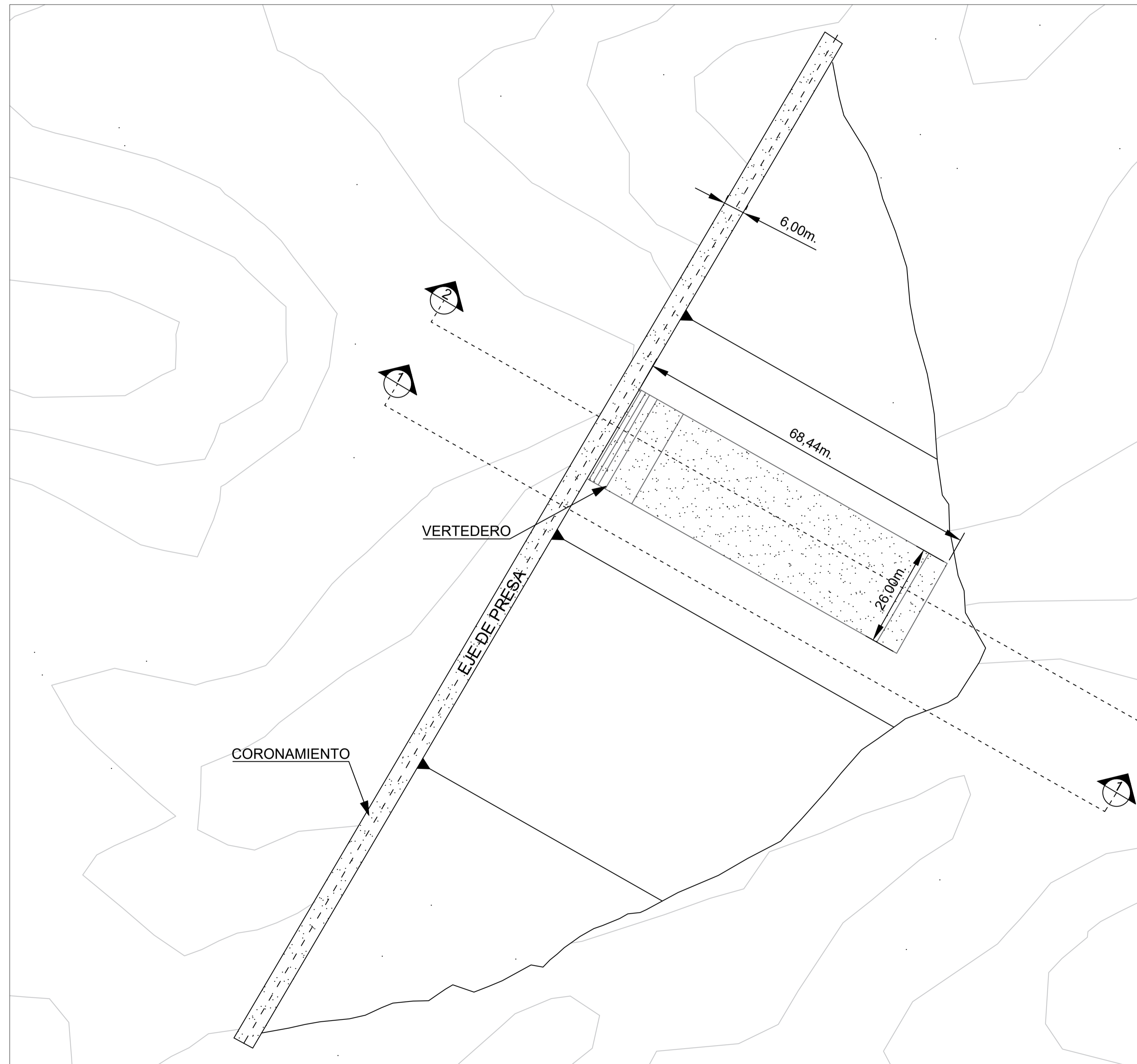
SECCIÓN 2-2 DE CIERRE DE PRESA DE HCR CON VERTEDERO EN EL CUERPO DE PRESA
