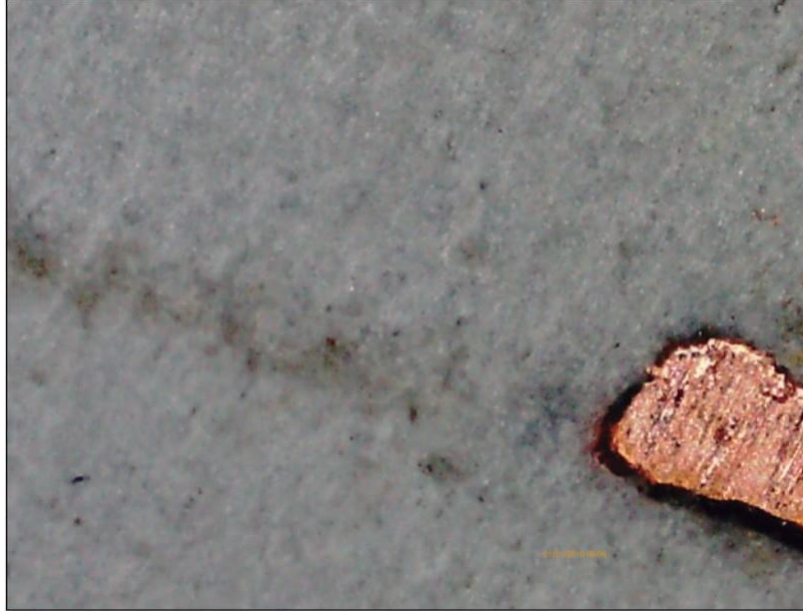
Fig. 25. Interfaz de soldadura ampliada posterior al ensayo de flexión en material PPM. Visión de un hilo para comparar con la continuidad del material.
