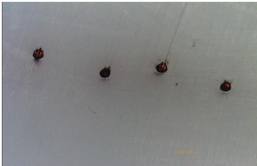
Fig. 24. Interfaz ampliada de soldadura posterior a flexión
