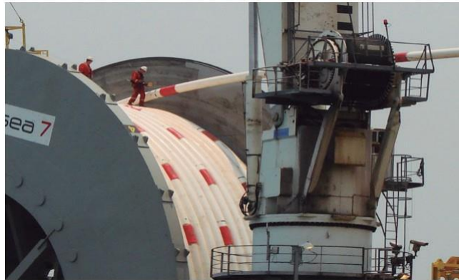
Fig. 20. Vista de las tuberías de acero recubiertas con materiales poliméricos enrolladas sobre carretel en barco para su transporte hasta estación offshore
