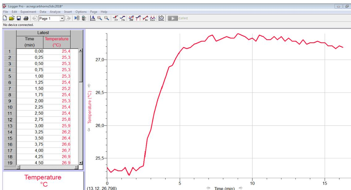
**FIGURA 4.** Gráfico de evolución de la temperatura en el tiempo, para un ensayo con carbón de acacia negra
