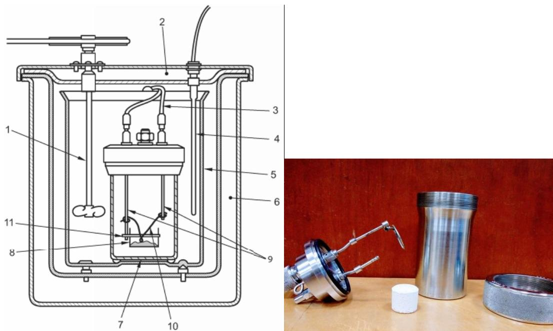
**FIGURA 3. Aparato de ensayo según ISO 1716:2010.** Leyenda: 1- Agitador, 2- Tapa del depósito aislado, 3- Cables de ignición, 4- Dispositivo de medición de la temperatura, 5- Vaso calorimétrico, 6- Depósito aislado, 7- Bomba calorimétrica, 8- Crisol, 9- Electrodo, 10- Cable de encendido, 11- Apoyo de crisol
