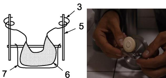
**FIGURA 3. Cigarrillo colocado en el crisol.** Leyenda: 3- Cables de encendido, 5- Electrodo, 6- Cigarrillo, 7- Crisol
