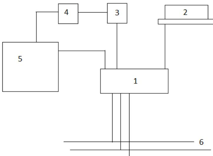
**FIGURA 1.** Diagrama de conexiones del sistema para ensayos de ignición. Leyenda: 1- Caja de conexiones, 2- computadora, 3- transformador, 4- caja de conexión con led, 5- calorímetro, 6- Red, Corriente alterna, 220V, 50 Hz.
