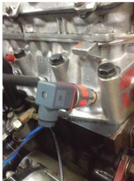
Fig. 5. Montaje en el cilindro n°4 del sensor para medición de la presión en tiempo real sin combustión
