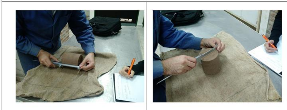
Fotos 48 y 49. Ensayo de compresión suelo – cal. Medición de probeta
