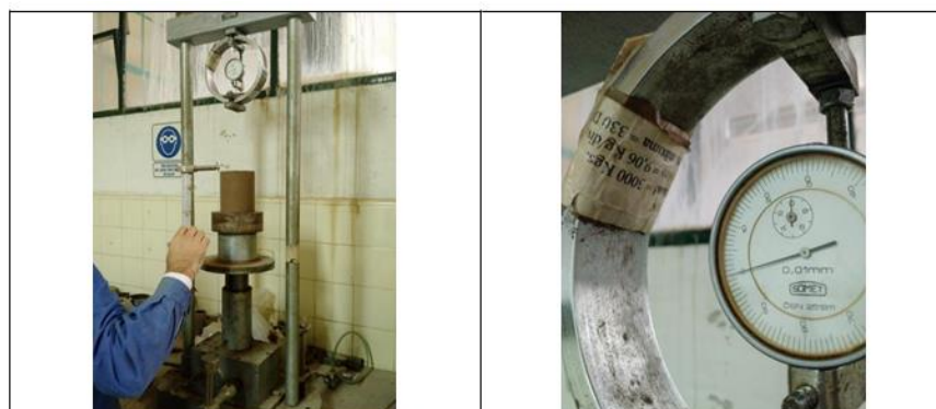
Fotos 50 y 51. Ensayo de compresión suelo – cal. Máquina de ensayo y factor de escala Kgf/num. de divisiones
