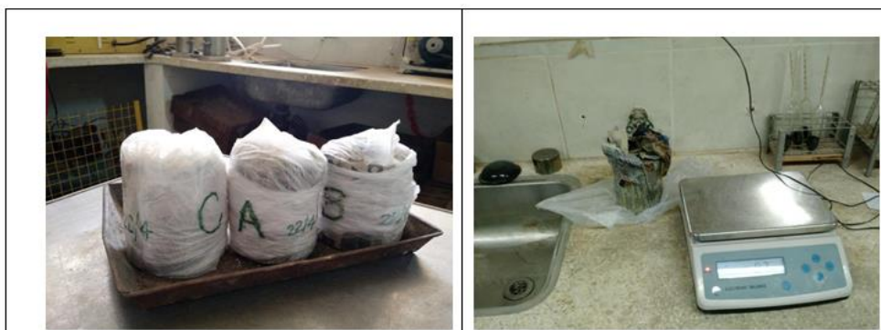
Fotos 46 y 47. Ensayo de compresión suelo – cal. Preparación de probeta
