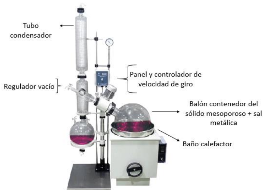
Figura 3.1. Evaporador rotatorio para impregnar los catalizadores. Recuperado y modificado de https://es.aliexpress.com/item/32760995182.html [16]
