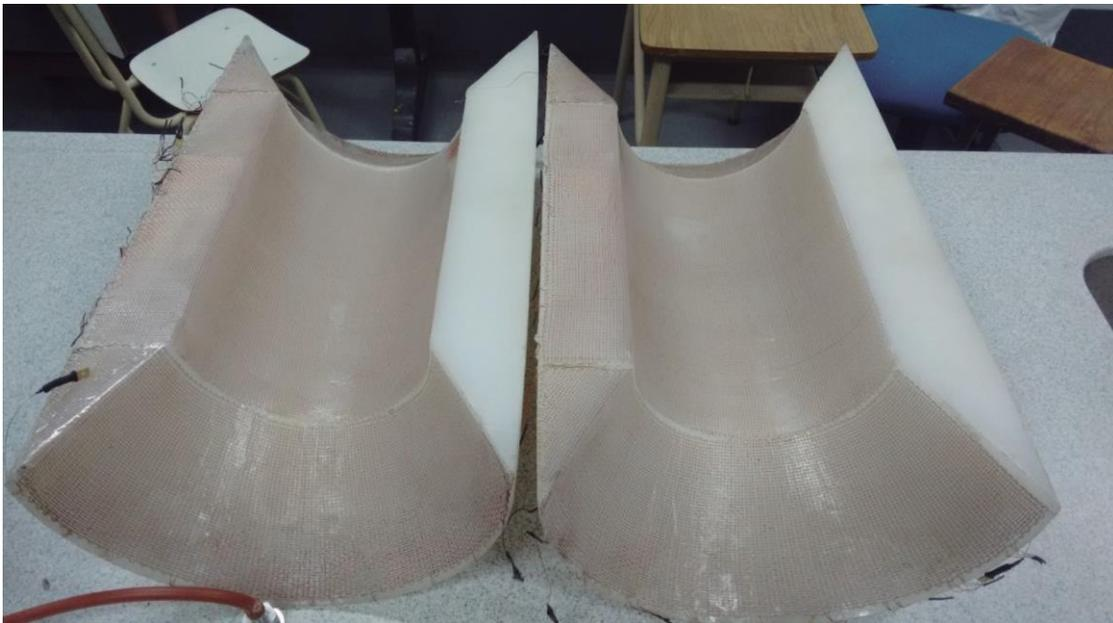
**Fig. 12. Mallas insertadas completamente en ambas mediacañas**
