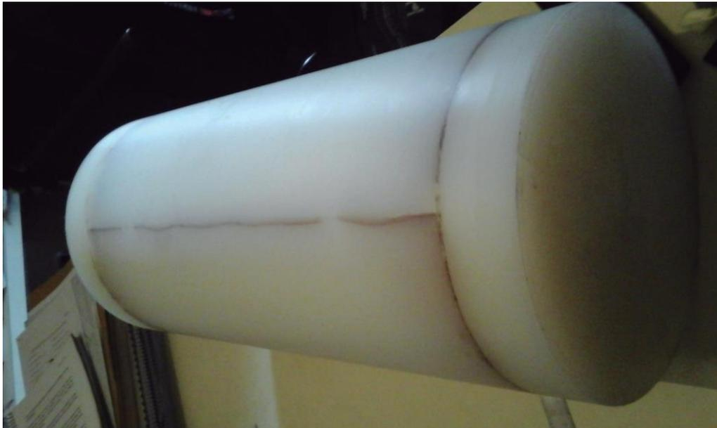
**Fig. 15. Mediacañas encastradas. Sistema listo para soldadura**
