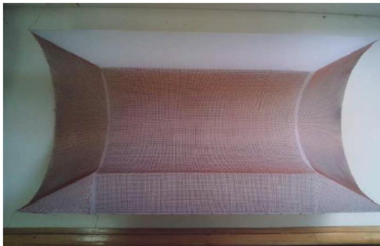
**Fig. 8. Media caña con las mallas colocadas para su inserción**
