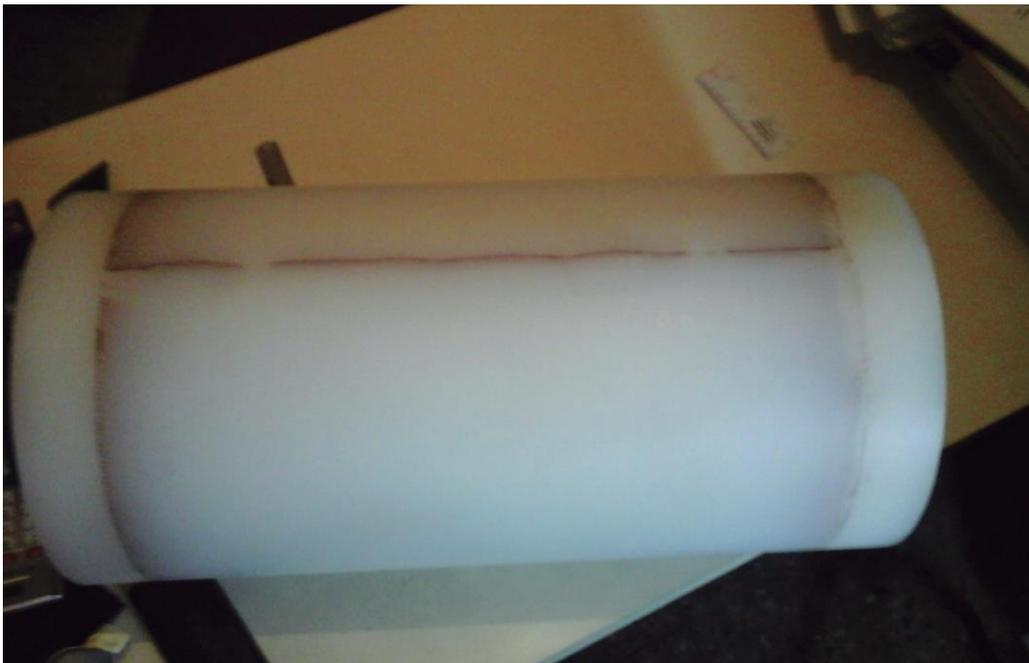
**Fig. 17. Tubo y mediacañas a escala real soldado**
