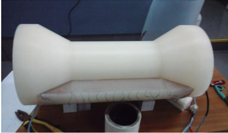
**Fig. 13. Encastre de una mediacaña al tubo**
