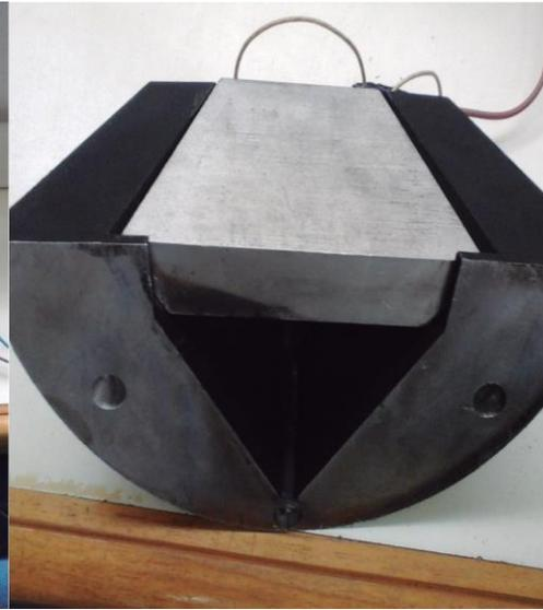
**Fig. 7. Insertador zona troncocónica**
