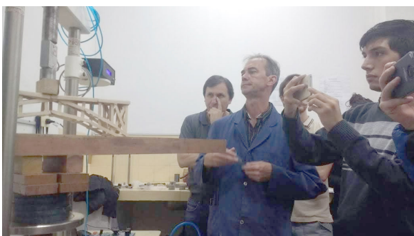
Actividad en tema Estructura: Elaboración y ensayo en laboratorio de maqueta de puente.
