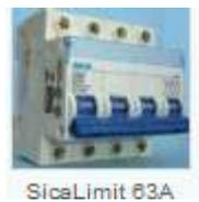
**Llave diferencial**, también llamado disyuntor por corriente diferencial o residual, es un dispositivo electromecánico que se coloca en las instalaciones eléctricas con el fin de proteger a las personas, produce el corte instantáneo de corriente eléctrica ante cualquier situación de riesgo, ya sea por cortocircuito, por descarga, sobrecarga o fuga. Dicha selección del disyuntor correcto depende de la potencia instalada.
