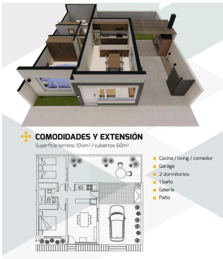
Figura 50. Renderizado y plano anteproyecto del prototipo VES en Paraná.
