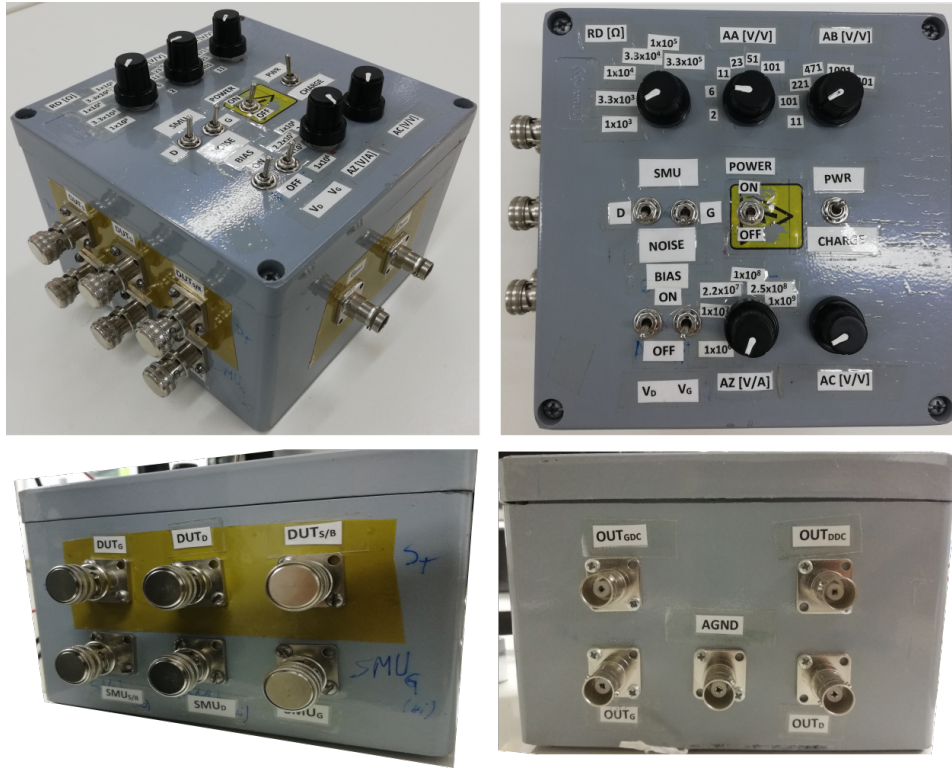
Figura 5.3: Imagen de la implementación física del sistema de acondicionamiento y polarización.
