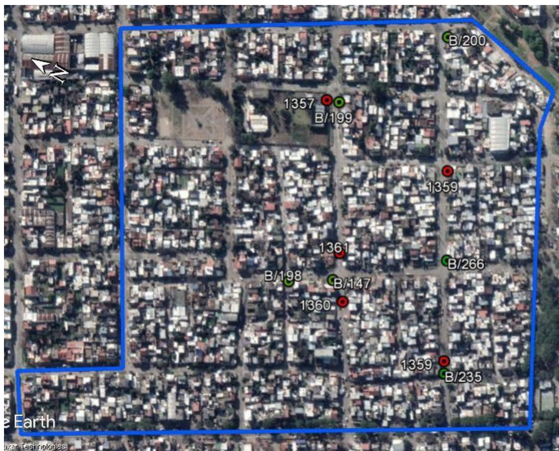
Figura 67: Mapa de ubicación de lugares donde se realizaron las tomas de muestra. Referencias: ● Muestras para DBO y DQO ● Muestras para análisis Bacteriológico.
