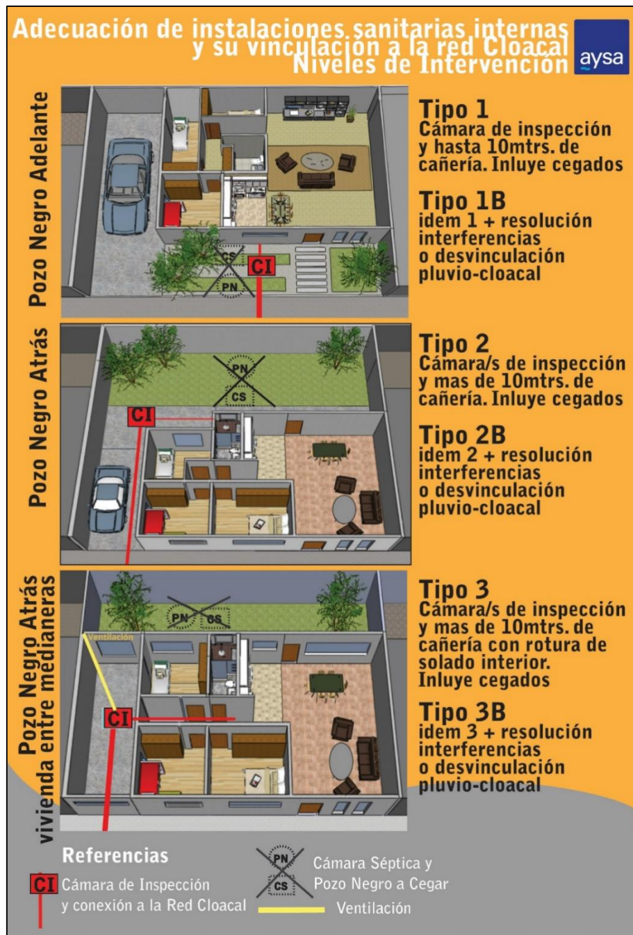
Figura 41: “Adecuación de instalaciones sanitarias internas y su vinculación a la red cloacal” Fuente: AySA (ver ANEXO 5)
