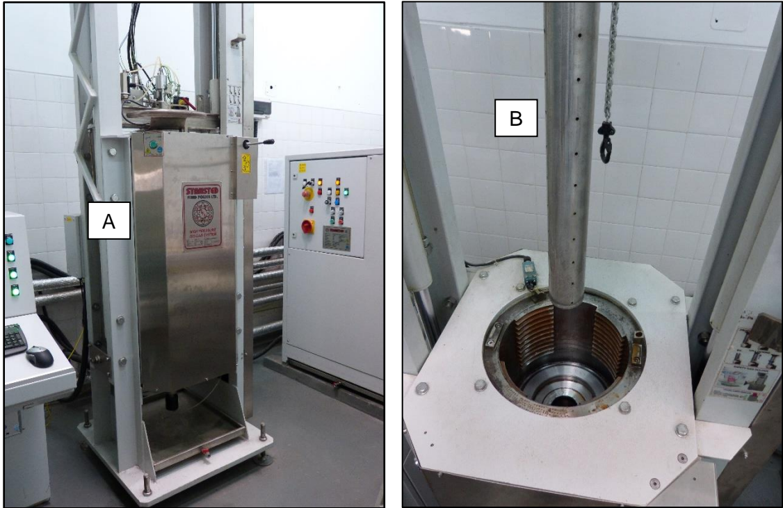
Figura 5: Módulo prensa del equipo de APH marca Stansted Fluid Power Ltd. modelo Iso-Lab System modelo FPG9400:922. A) Cilindro de alta presión, B) Canasta para la carga de muestras.
