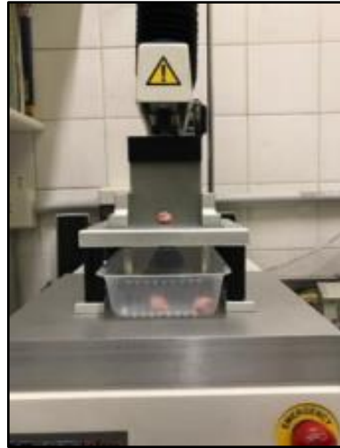
Figura 11: Analizador de textura marca Stable Micro Systems modelo TA.TX plus equipado con celda de Warner-Bratzler de cuchilla triangular
