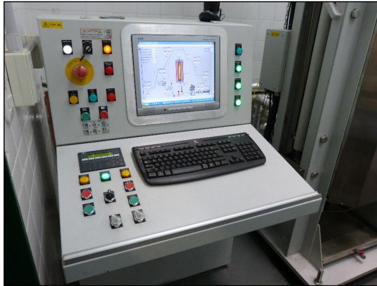
Figura 4: Imagen del módulo de control del equipo de APH marca Stansted Fluid Power Ltd. modelo Iso-Lab System modelo FPG9400:922.
