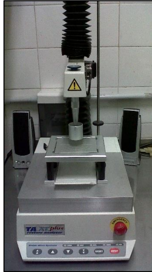
Figura 12: Analizador de textura marca Stable Micro Systems modelo TA.TX plus equipado con accesorio cilíndrico para ensayo TPA.
