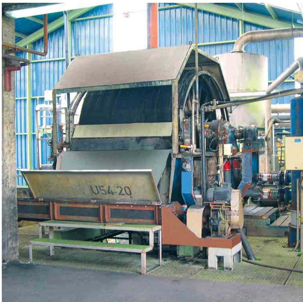
Con la utilización de las nuevas tecnologías basadas en PLC y ordenadores, se consigue llegar a un control absoluto del funcionamiento de estos filtros. A través del panel de control puede quedar perfectamente establecido el ritmo más adecuado del filtro definiendo parámetros como:
