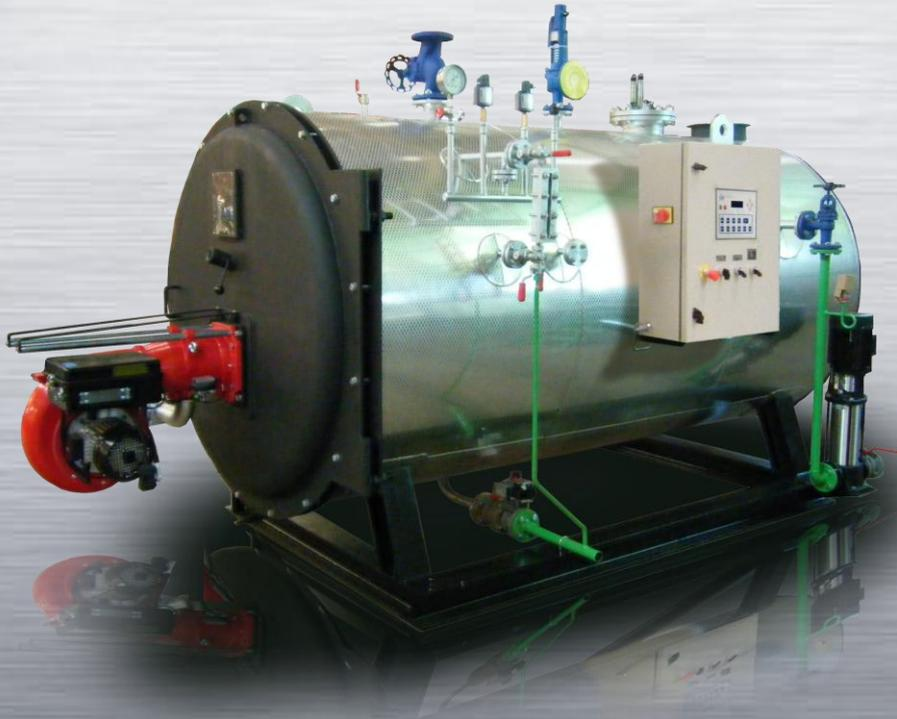
La combustión se produce y completa dentro del **hogar, totalmente rodeado y refrigerado por agua**, retornando los humos resultantes a través del mismo hogar, pasando posteriormente por el haz tubular con el **aprovechamiento al máximo del calor**, para finalmente expulsarlo a la atmósfera por la chimenea.
