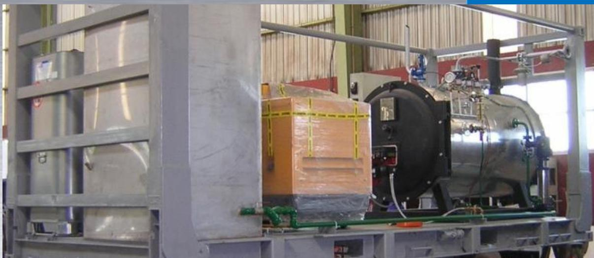
Un **registro** en la parte superior de la caldera permite realizar la revisión del **interior de la caldera**.
