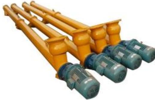
Ilustración 4.74. Tornillo helicoidal. Obtenido de: <https://cutt.ly/0hUsuY5>
