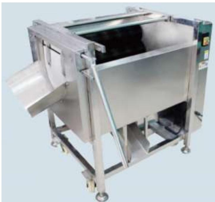
Ilustración 4.55. Lavadora/Peladora. Obtenida de: <http://imarca.com.ve/Lavadora-general-de-Alimentos.php>
