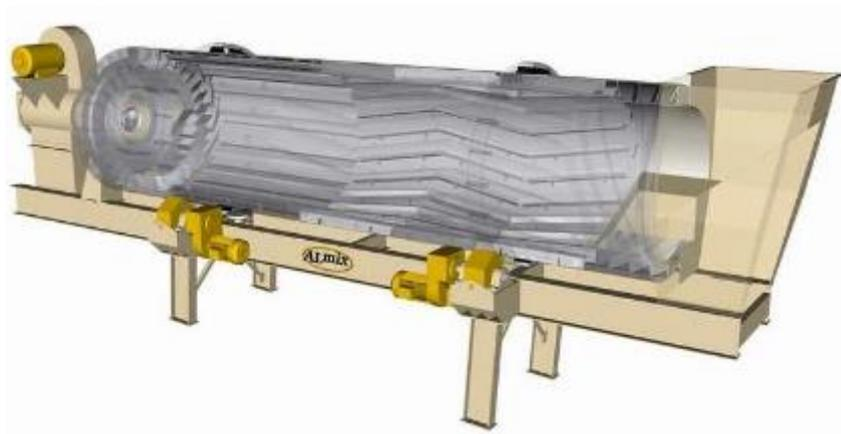
Ilustración 4.35. Secador rotatorio. Obtenido de [https://es.wikipedia.org/wiki/Archivo:Tambor\\_secador,\\_Secador\\_rotativo.jpg](https://es.wikipedia.org/wiki/Archivo:Tambor_secador,_Secador_rotativo.jpg)
