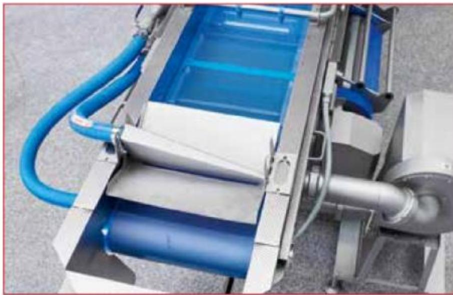
Ilustración 4.61. Sistema de soplado y succión. Obtenido de: <https://www.kronen.eu/es/company>
