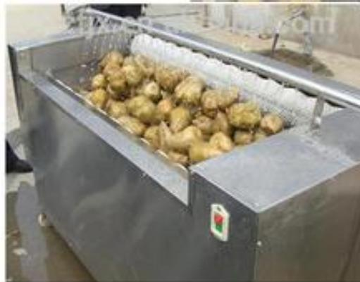
*Figura N°2 – Equipo de descascarado*
