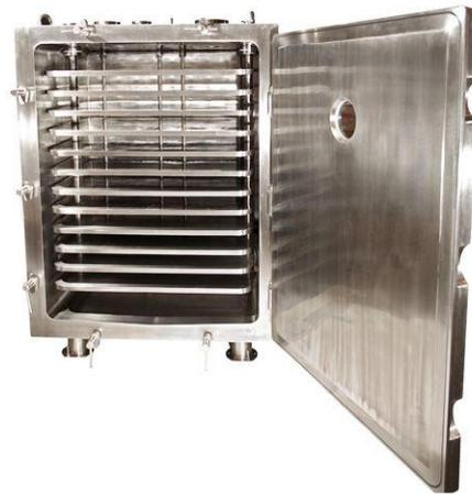
*Figura N° 25 – Secadero de bandejas*
