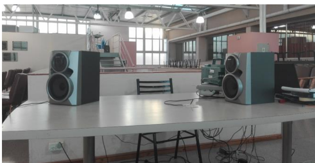
Fig. 10. Disposición de parlantes y micrófonos para ensayos feed-forward
