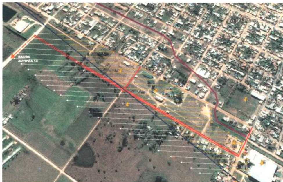
Figura 6-22: Escurrimiento de las aguas según Topografía
