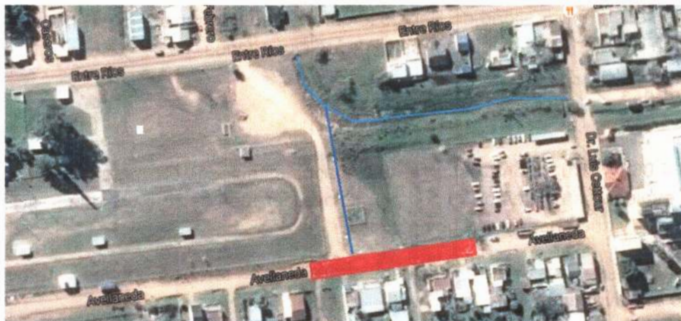
Figura 9-2: Proyección de Calle a pavimentar y desagüe
