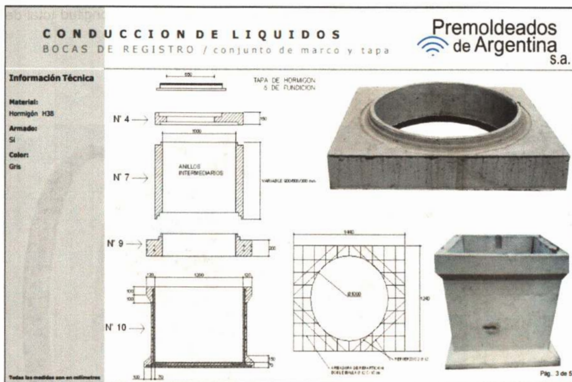
FIGURA 8-16: Elementos que conforman una Cámara de registro prefabricada.
