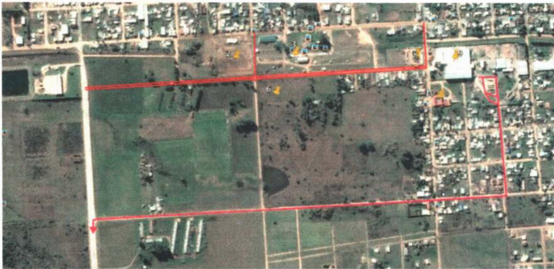
Figura 6-2: Circulación tránsito pesado para camiones de INSA
