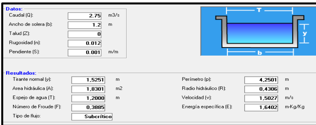
Figura V-39 Dimensionado cuneta tramo 3. Fuente: HCANALES
