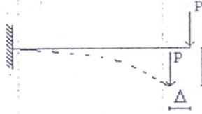
La barra flexible tiene por lo tanto la forma de una banda fina, y frecuentemente se la denomina barra fina flexible. En la barra flexible, la ecuación diferencial de la línea elástica está dada por:
