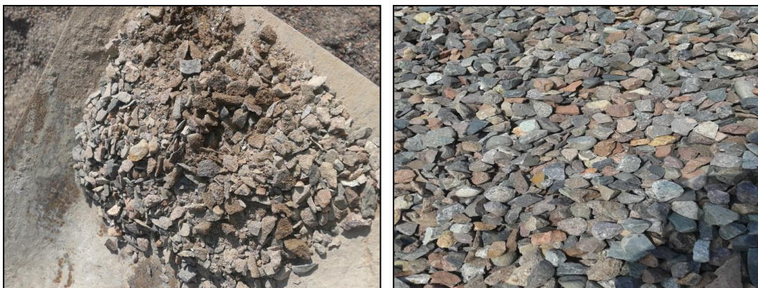
Fig. 3. Árido Triturado. Se observa a la izquierda el árido fino y a la derecha el acopio del árido grueso. Se pueden ver las diferencias de color, forma y en los áridos finos, la cantidad de polvo que contiene.
