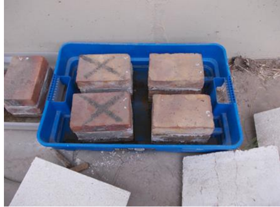
Figura N°2: inmersión de probetas en agua
