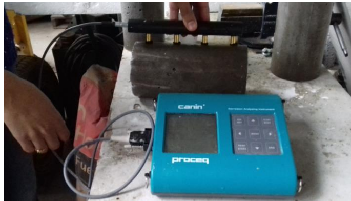
Fig. 3. Medición de resistividad eléctrica en probetas.
