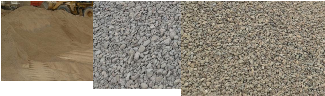
Fig. 2. Áridos Naturales. Se observan los acopios de las diferentes fracciones donde fueron extraídas las muestras. La foto de la izquierda es arena fina, la del medio es ripio y la de la derecha es lo denominado granza.
