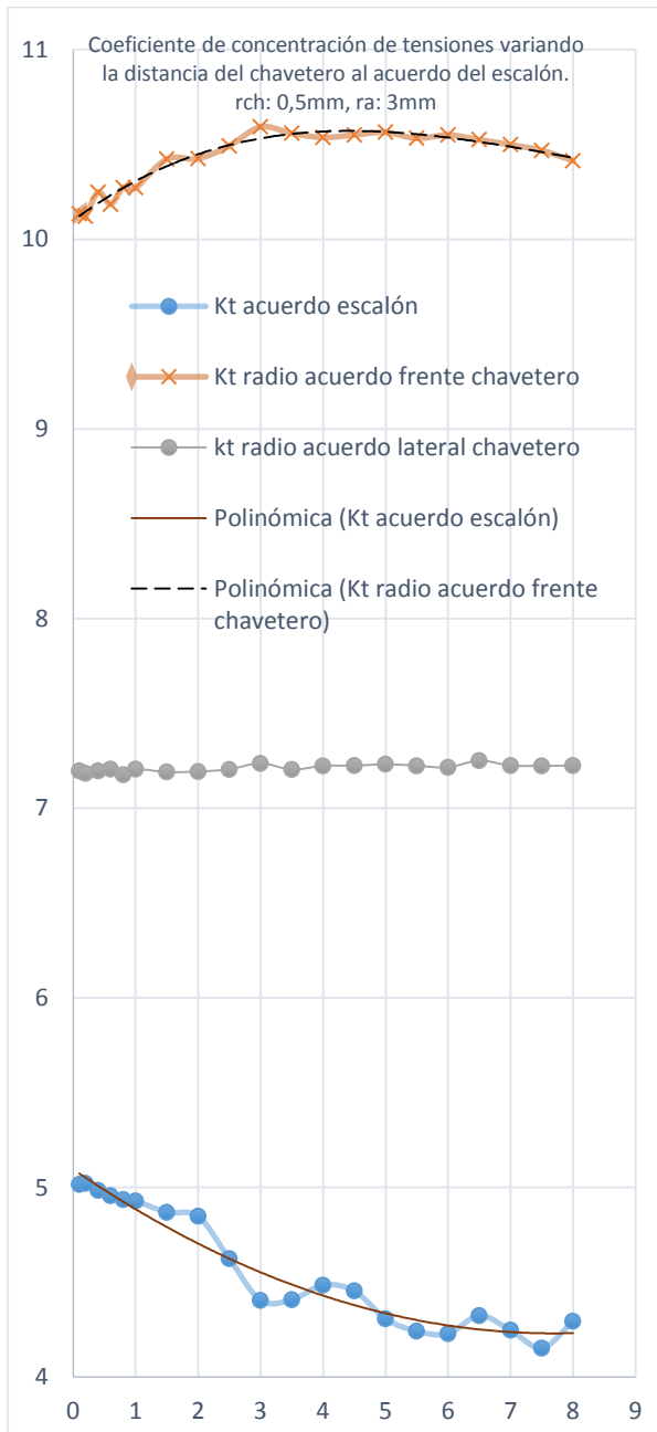
Fig. 6: Coeficiente de concentración de tensiones variando la distancia del chavetero al acuerdo del escalón. Fuente propia.
