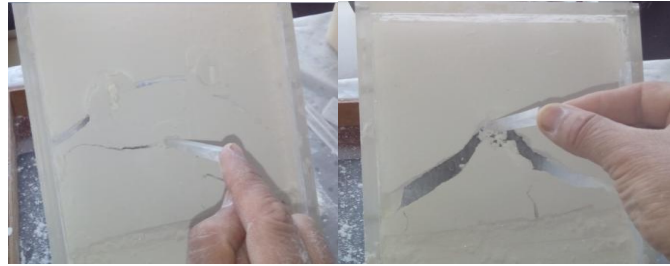
Fig. 2. Rotura y progreso. Falla presente en el interior del material granular.
