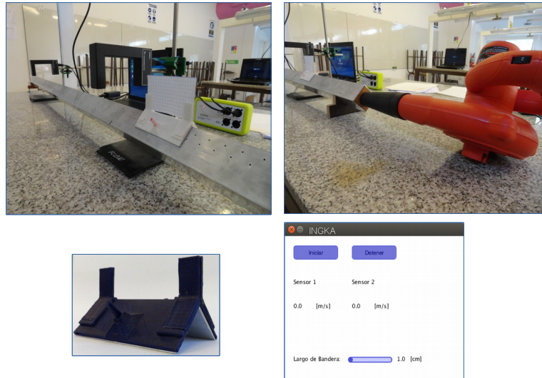
Fig. 1. Riel de aire con sopladora (paneles superiores); carro creado mediante impresión 3D (panel inferior izquierdo); aplicación para registrar la velocidad de los carros (panel inferior izquierdo).
