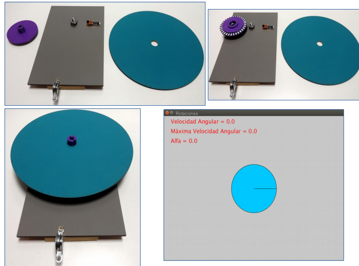
Fig. 3. Soporte hecho mediante impresión 3D con rodamiento axial, base y disco (paneles superiores). Sistema montado y listo para medir (panel inferior izquierdo). Aplicación para PC (panel inferior derecho).
