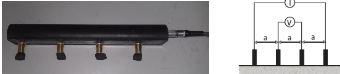
Fig. 2. Sonda de Wenner utilizada para la medición de resistividad eléctrica.
