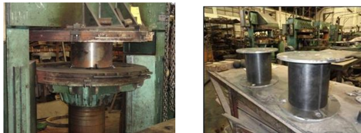
Fig. 2. Proceso de vulcanización de los aisladores. Dispositivos desmoldados.
