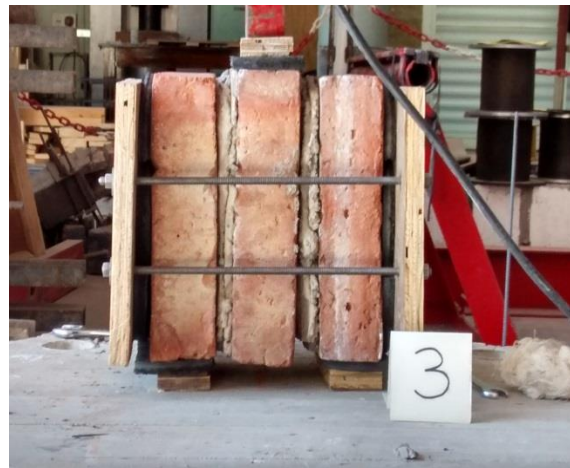
Figura N°6: ensayo de adherencia de probetas
