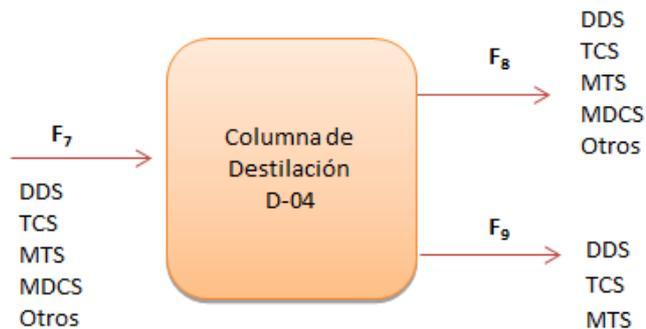
**Figura 8: Diagrama del balance de masa en la columna de destilación.**
