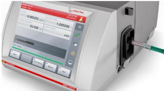
**Figura 22: Densímetro AntonPaar DMA 4500M**
