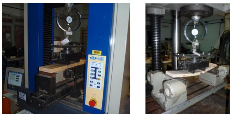
Figura 1. Ensayos estáticos de flexión. A la izquierda un cuerpo de prueba de pino resinoso y a la derecha uno de álamo
