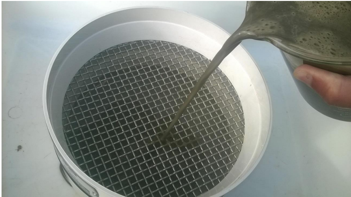
Imagen 60: Elaboración propia. Fotografías del tamizado húmedo en malla de 5660 \mu .
