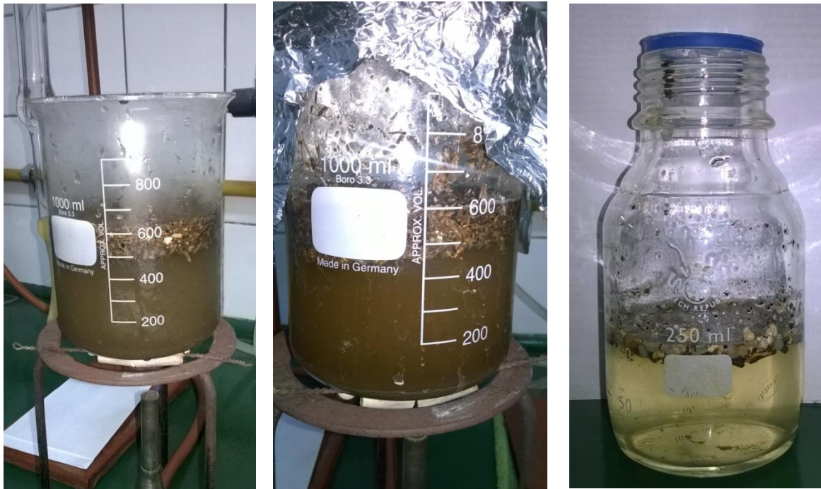
Imagen 31: Elaboración propia. Fotografías del proceso: Izquierda: Calentamiento de la muestra en mechero. Centro: Proceso de enfriado de la muestra. Derecha: Resultado del proceso de separación de los microplásticos con vestigios de resaca.
