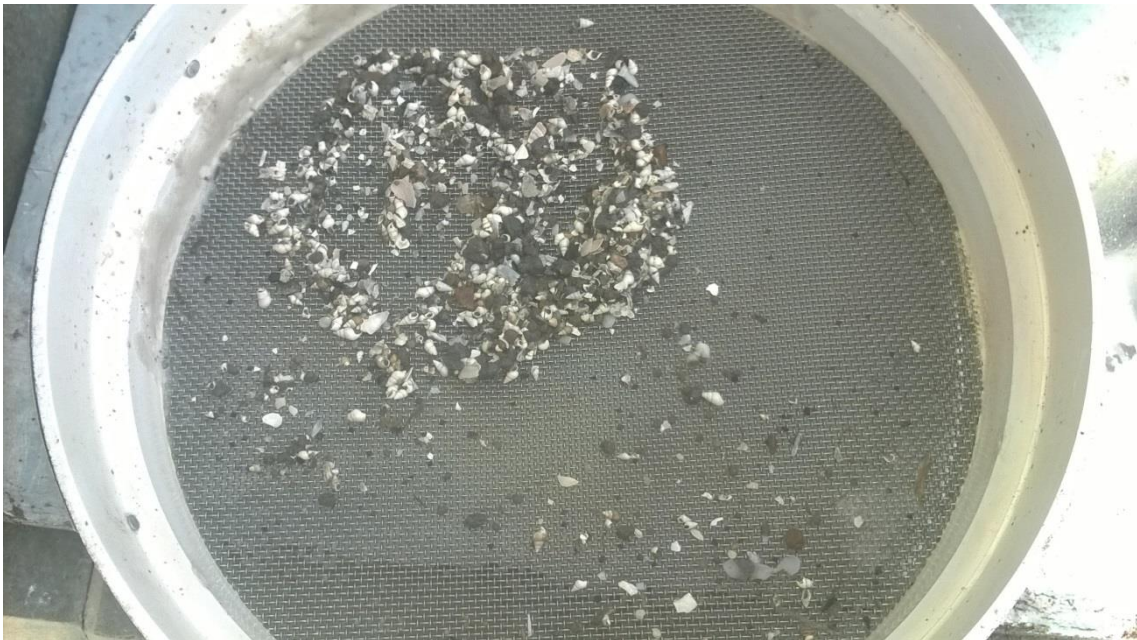
Imagen 61: Elaboración propia. Fotografía del material retenido en la malla de 1000 \mu , se lo seca al sol dentro del mismo tamiz.
