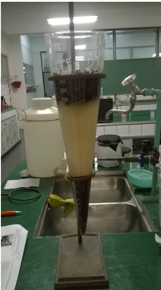
Imagen 24: Elaboración propia. Fotografía de muestra de sedimento costero de marisma, en una solución 5M de NaCl. Proceso de flotación en Cono Imhoff.
