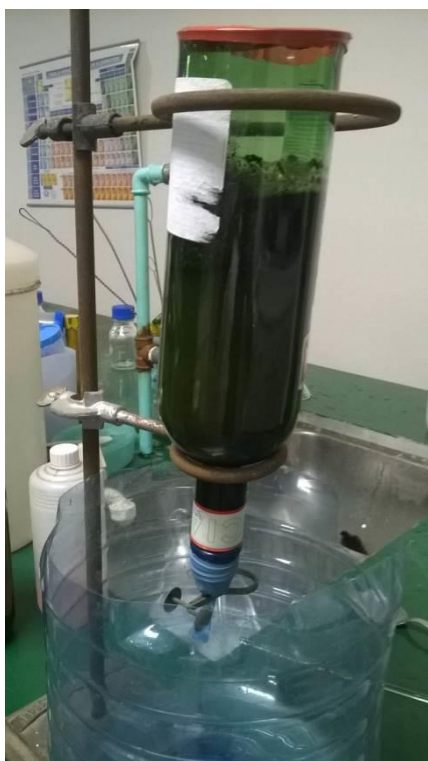
Imagen 34: Elaboración propia. Fotografía de la adaptación de una botella de vidrio para la separación por densidades.
