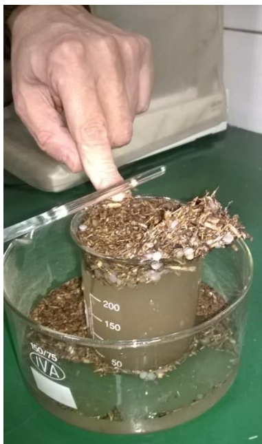
Imagen 43: Elaboración propia. Fotografía del procedimiento de separación por rebase. Obsérvese que se tuvo que recurrir al uso de una varilla de vidrio, ya que el material se eleva en bloque y no permite una separación eficaz.
