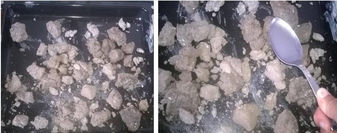
Imagen 58: Elaboración propia. Fotografía de materiales secos con alto contenido en arcillas. Puede observarse la gran cohesión y dureza de los materiales
