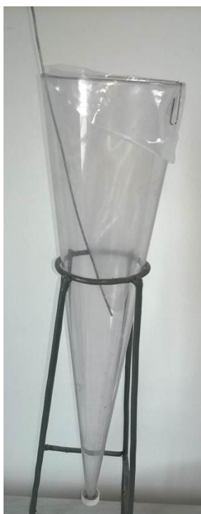
Imagen 63: Elaboración propia. Fotografía de la ubicación de la manga dentro del Cono Imhoff.
