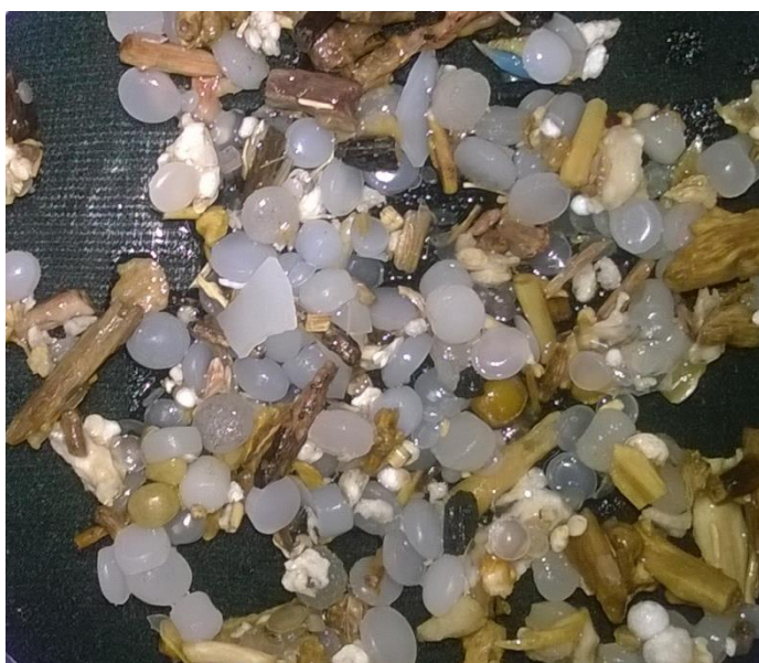
Imagen 33: Elaboración propia. Fotografía del resultado de la degradación de la muestra con H 2 O 2 al 35% durante 7 días.
