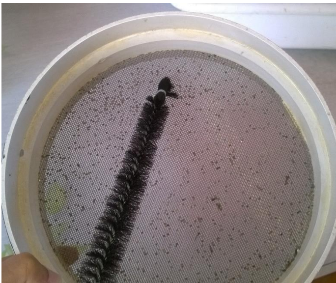
Imagen 57: Elaboración propia. Fotografía de la remoción del material retenido en las aberturas del tamiz de 1000 \mu .
