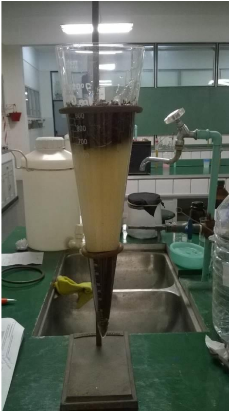
Imagen 44: Elaboración propia. Fotografías Izquierda: ensayo 1 en Cono Imhoff sin tamizar (la fracción sedimentable ocupó aproximadamente 100 ml) y Derecha: ensayo 4 en Cono Imhoff con tamizado previo (la fracción sedimentable ocupó menos de 40 ml)
