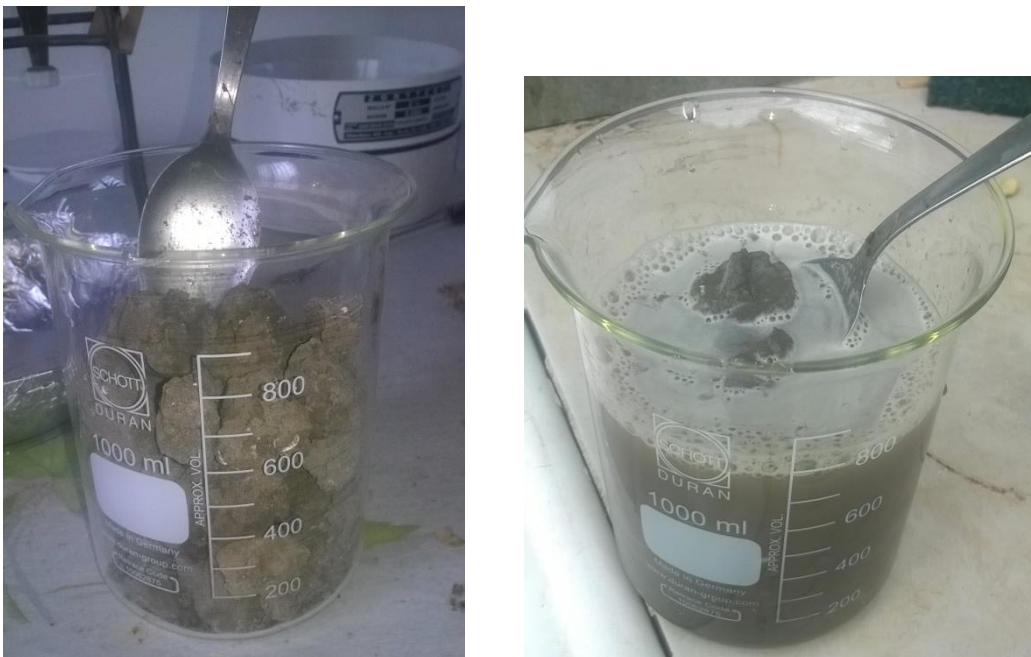
Imagen 59: Elaboración propia. Fotografía de la disgregación de las arcillas con agua de mar.
