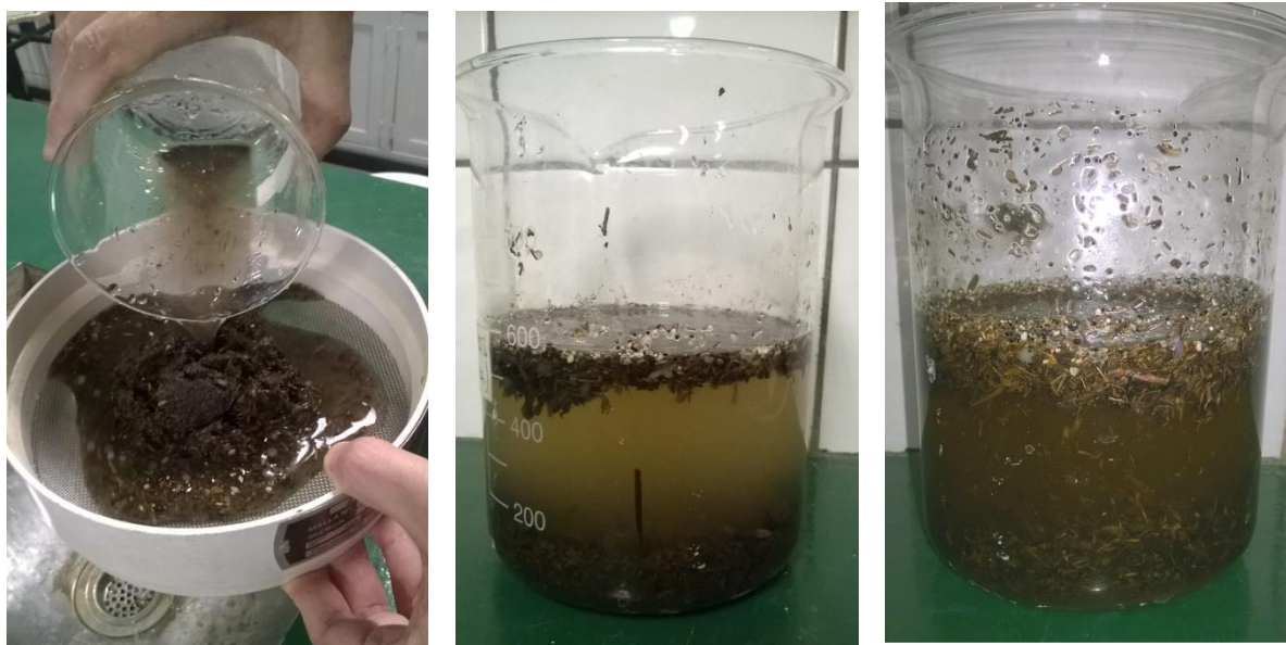
Imagen 36: Elaboración propia. Fotografías Izquierda, lavado del material decantado en salmuera de la NOAA, con agua corriente, en el tamiz de 1mm de abertura de malla. Centro, material precipitado luego de 1hr de reposo en agua de mar. Derecha, decantación en la salmuera de la NOAA, notar la diferencia en la cantidad de material precipitado, y la disminución del material en suspensión.
