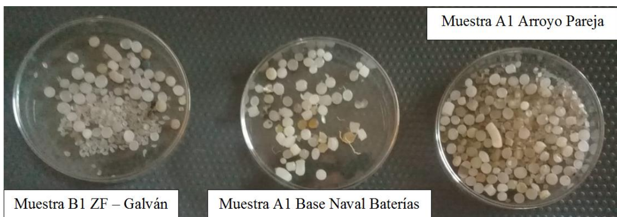
Imagen 86: Elaboración propia. Fotografías de la comparación de los microplásticos primarios hallados en el muestreo preliminar del Estuario de Bahía Blanca.
