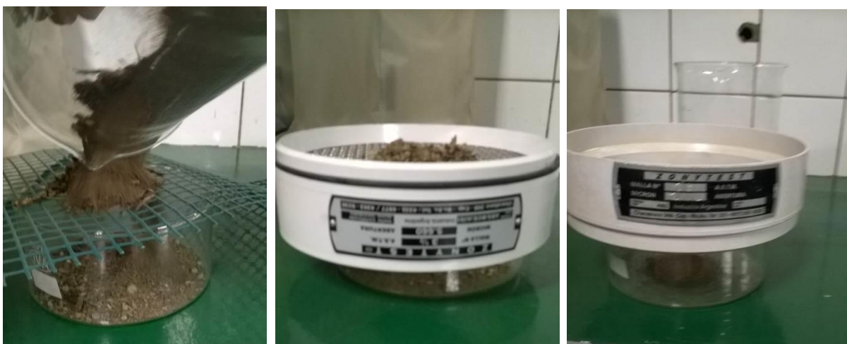
Imagen 41: Elaboración propia. Fotografías del proceso de tamizado sucesivo. Izquierda, tamizado en malla >1cm. Centro, tamizado en malla 5mm. Derecha, tamizado en malla 1mm.
