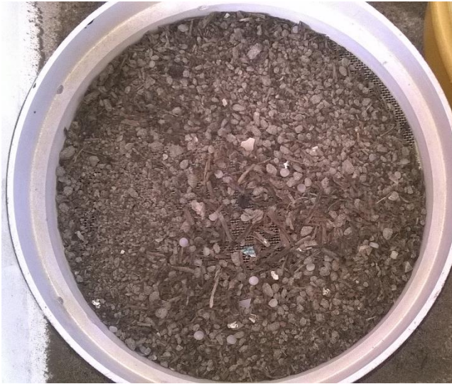
Imagen 56: Elaboración propia. Fotografía del material retenido en el tamiz de 1000 \mu .
