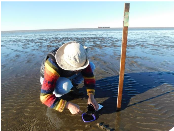
Imagen 52: Elaboración propia. Fotografía de la extracción de muestras utilizando un molde cuadrado. Se clava el molde en el sedimento, y se extrae del interior del mismo la muestra con ayuda de una cuchara metálica.
