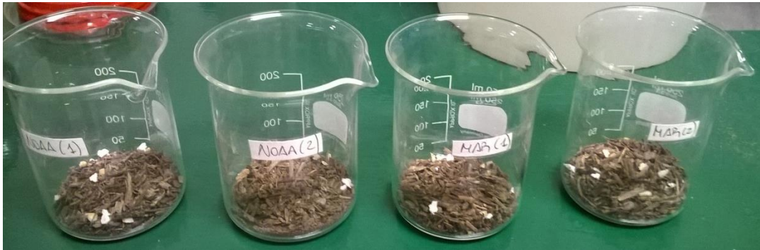
Imagen 37: Elaboración propia. Fotografía de la construcción de las muestras artificiales para el ensayo comparativo entre el agua de mar y la salmuera de la NOAA
