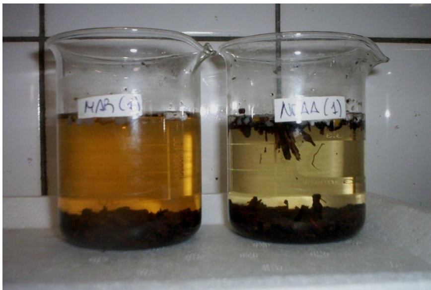
Imagen 38: Elaboración propia. Fotografía de vaso de precipitados de la izquierda, contiene una muestra luego de la ebullición y posterior decantación de los materiales en agua de mar. Derecha, mismo proceso pero con utilizando salmuera de la NOAA.
