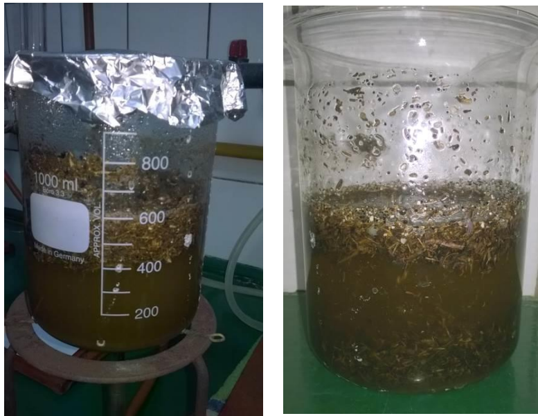
Imagen 35: Elaboración propia. Fotografías Izquierda, material con flotabilidad positiva en salmuera de la NOAA, llevada a mechero. Derecha, material decantado en salmuera de la NOAA luego de una semana de reposo.
