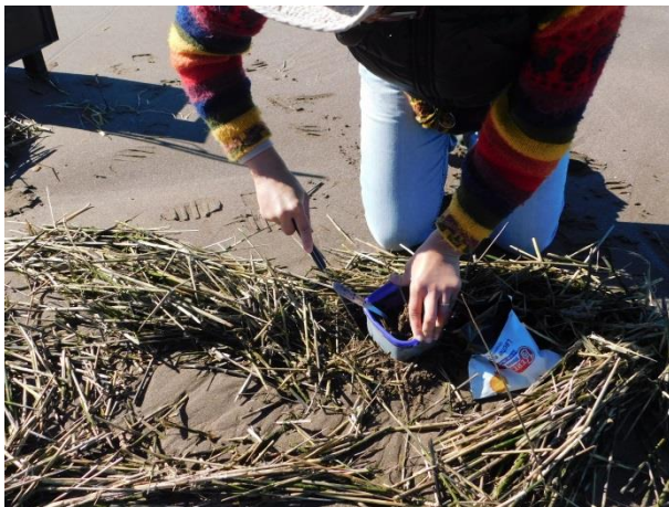
Imagen 53: Elaboración propia. Fotografía del recorte de la resaca de los laterales del molde con un cuchillo para extraer las muestras.
