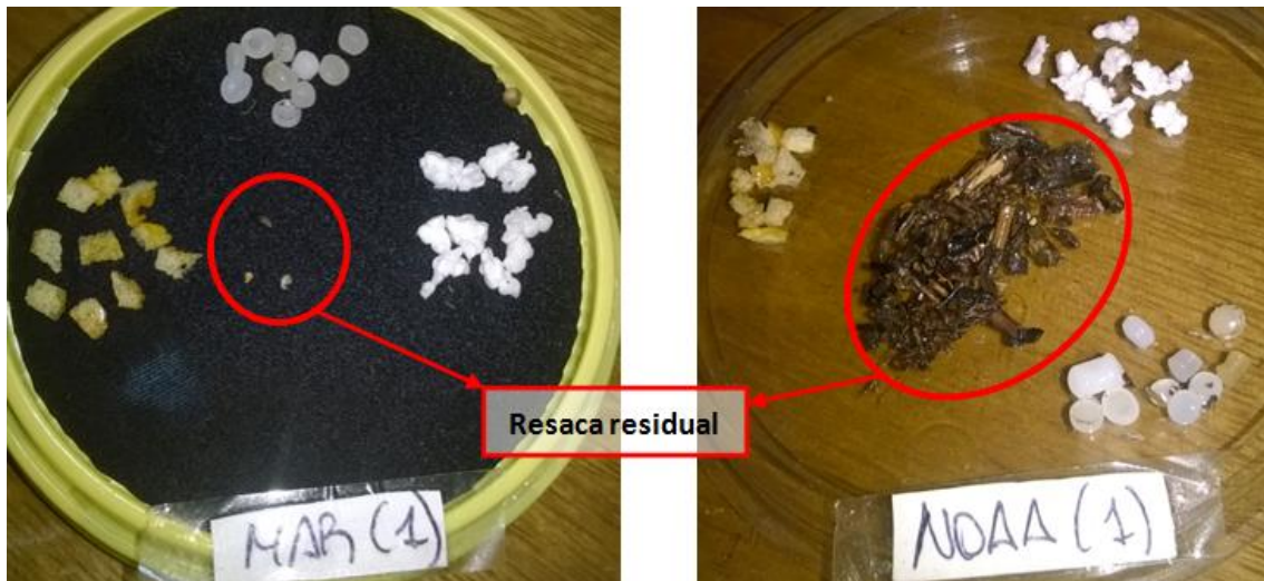
Imagen 40: Elaboración propia. Fotografía Izquierda, resultado de la extracción de microplásticos de una muestra artificial utilizando agua de mar. Derecha, resultado de la extracción de microplásticos de una muestra artificial utilizando salmuera de la NOAA. Notar la gran cantidad de resaca en comparación con la muestra en la que se utilizó agua de mar.
