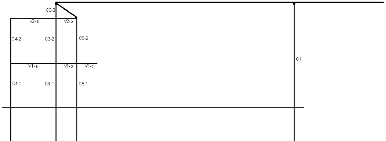
Figura nº 07-27: Esquema estructural pórtico nº 1
