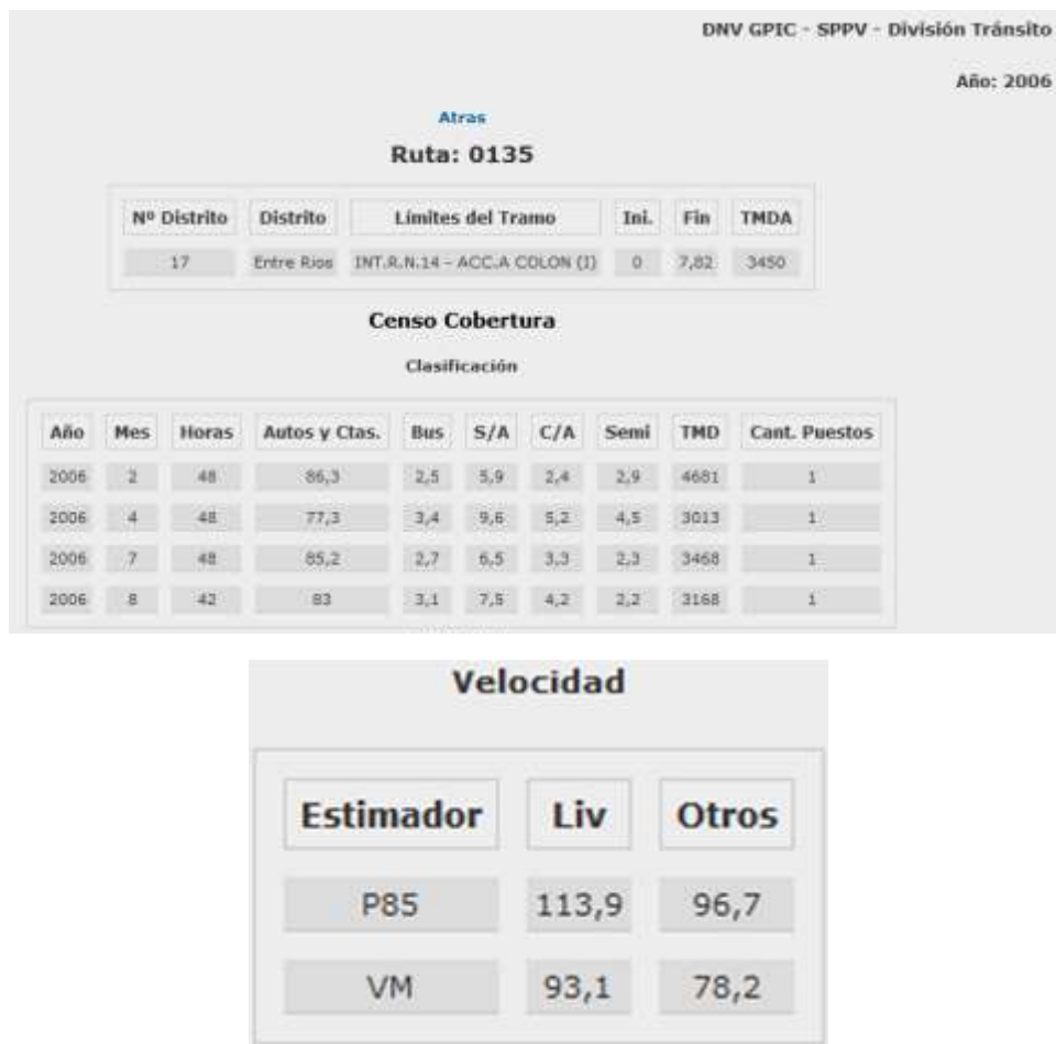
Figura N° 8-2: Ejemplo de relevamiento de un censo de cobertura realizado por DNV para un tramo de ruta.
