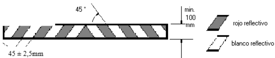
Fig. N° 2.10 - Bandas reflectivas en paragolpes trasero.
