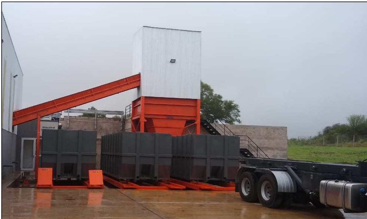
Fig. N° 1.2 - Planta de transferencia de residuos sólidos en San Pedro de Jujuy, Jujuy.
