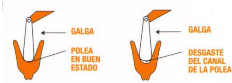
Fig. N° 8.21 - Control de la garganta de polea mediante galga patrón.
