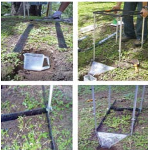
Figura 17: Instalación del simulador de lluvia en el campo (Monge, 2007)
