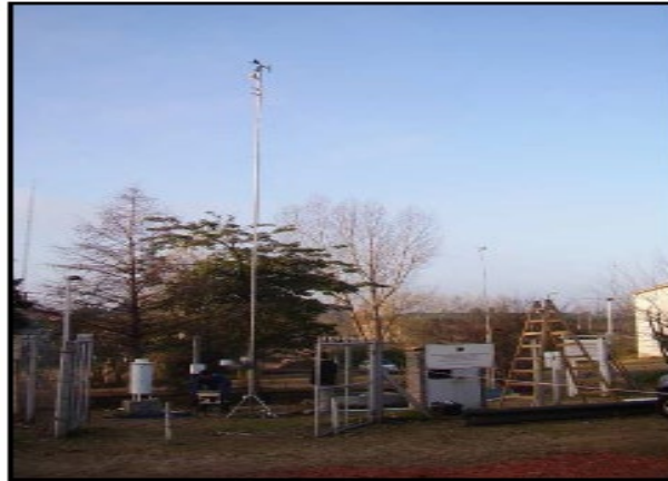
Figura4: Estación Automática. Laboratorio de Hidrología, Facultad Regional General Pacheco (UTN)
