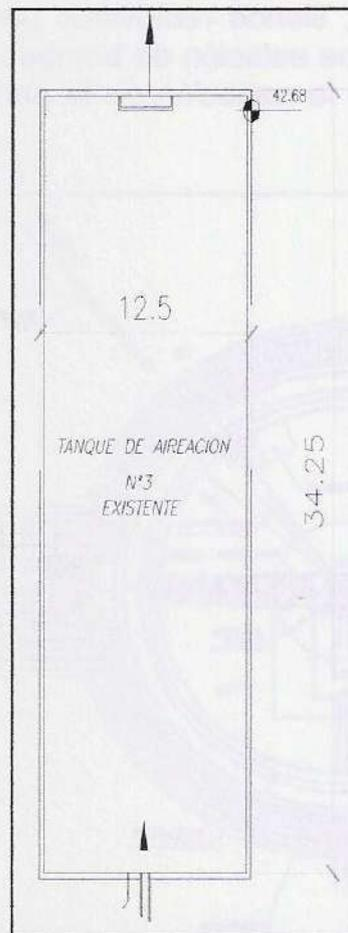
Figura 5-20. Esquema del tanque de aireación construido como inicio de obras de ampliación.
