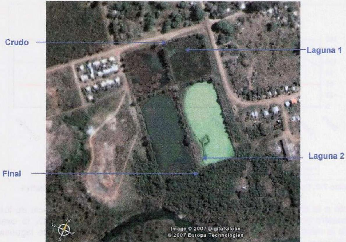
Figura 7-1. Puntos de muestreo del sistema de Colón.
