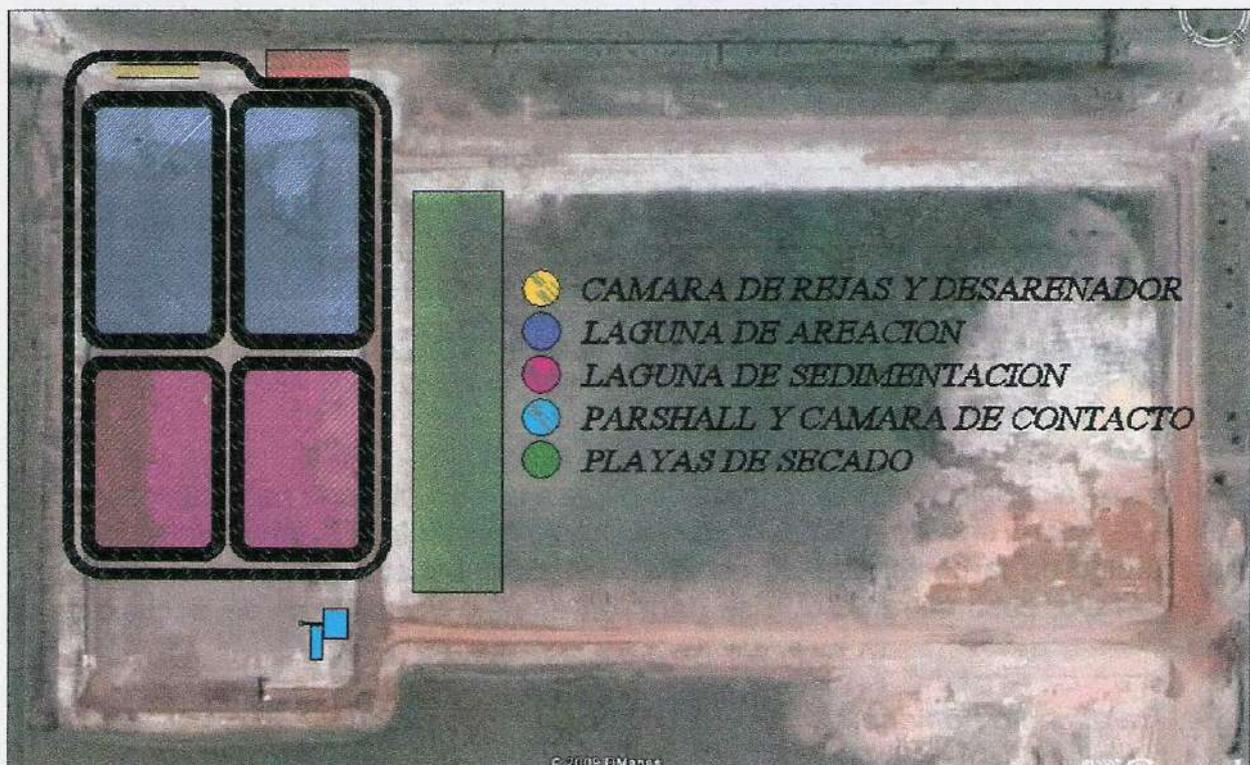
Figura 8-20. Esquema de procesos llevado a cabo en el proyecto de planta.
