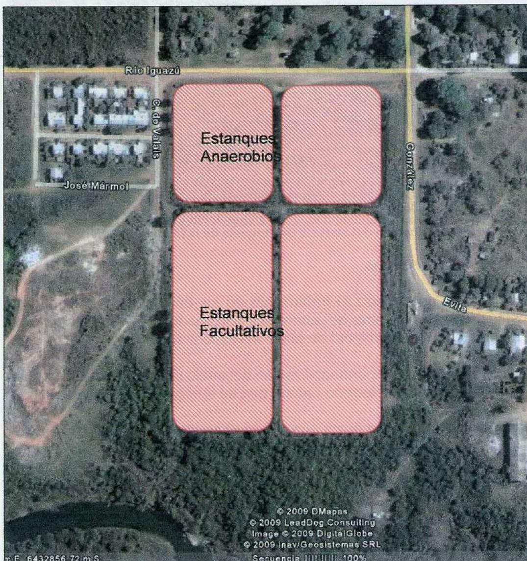
Figura 4-3. Configuración del sistema de lagunas de estabilización.
