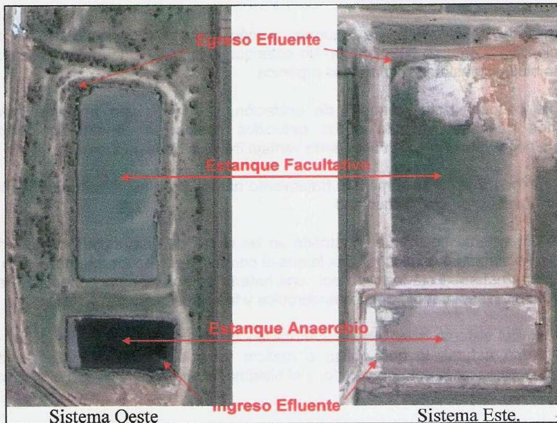
Figura 6-4. Esquema de los sistemas de lagunaje.
