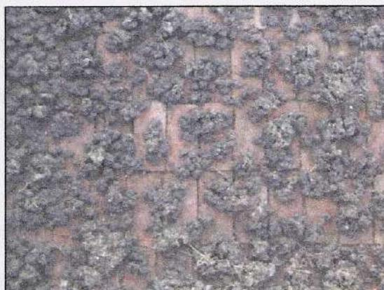
Figura 5-14. Playa de secados de barros. Barro disecado por el proceso natural.
