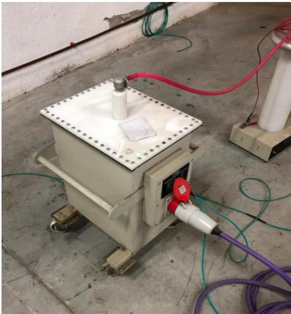
Fig. 5.14 a) Conexión a tierra de equipo de RD
