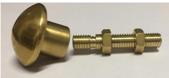
Fig. 5.2 a) Electrodo esférico y perno de fijación
