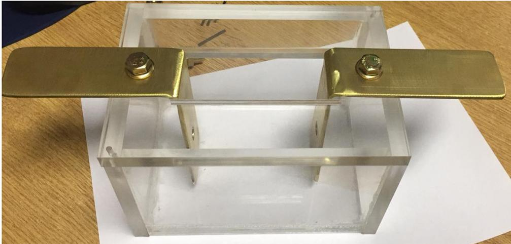
Fig. 5.4 Cuba con planchuelas sujetas a la tapa
