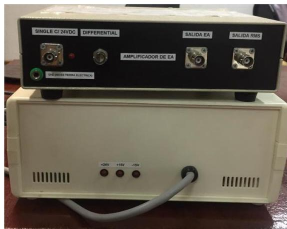
Fig. 5.9 Preamplificador y fuente de EA
