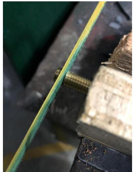
Fig. 5.7 b) Corte de hilos de varilla
