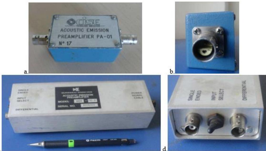
Preamplificadores de EA de distintos fabricantes, a y b con entrada diferencial y c y d con entradas simples y diferenciales
