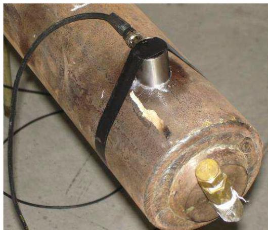
Ejemplo de fijación de sensor con cinta aislante
