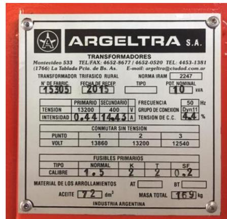
Fig. 7.1 b) Especificaciones Técnicas del transformador
