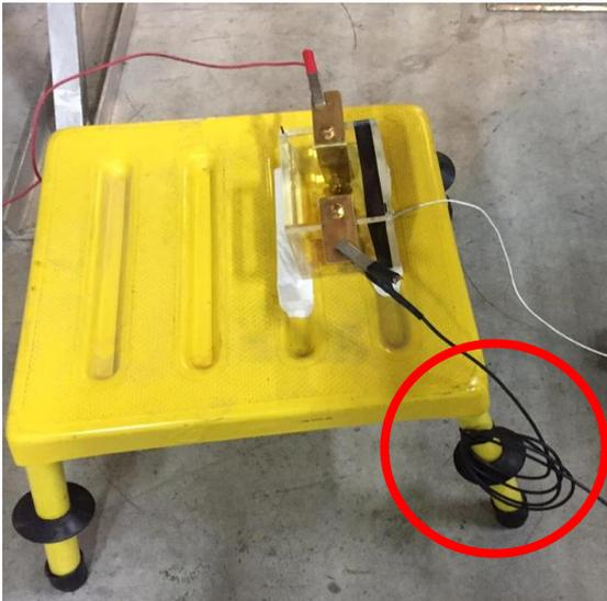
Fig. 5.16 a) Cable neutro atado a pata de taburete
