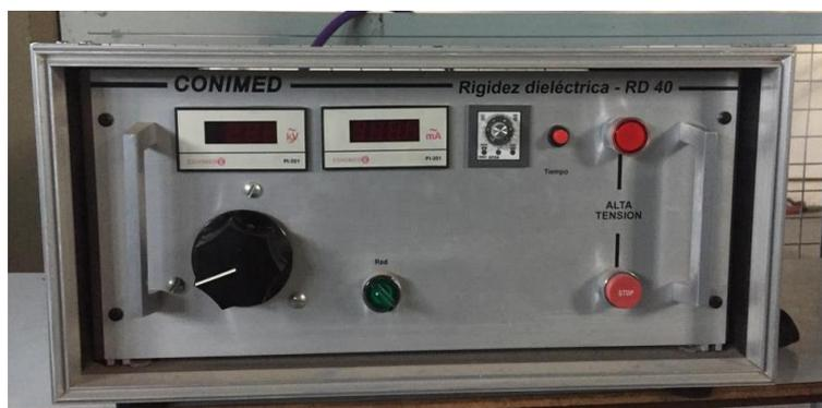
Fig. 5.11 Consola de control del Equipo de Rigidez dieléctrica
