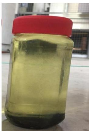
Fig. 5.30 Aceite deteriorado con carbono de coque
