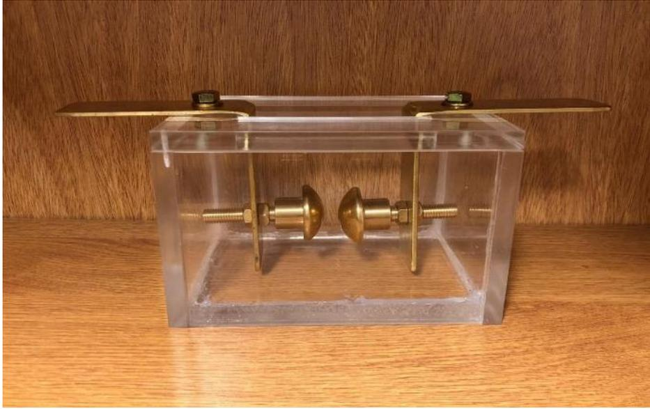
Fig. 5.6 Cuba finalizada donde se observan planchuelas, bornes de conexión, electrodos, tornillos de regulación, etc.
