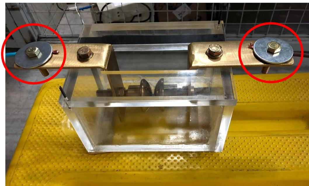
Fig. 5.26 Tornillos y arandelas de vuelo ancho en reemplazo de pinzas
