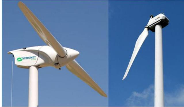
*Fig n° 7: Imagen de un aerogenerador bipala (izq.) y mono pala (der.)*
