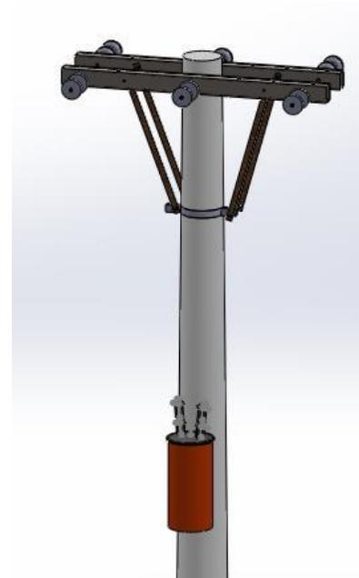
Ilustración 14 - Estructura terminal
