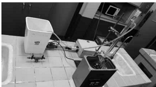
Figura 1: Equipo de reacción en baño de ultrasonido.
