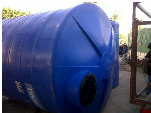
Figura 2. Cisterna rotomoldeada de polietileno utilizada en la construcción del biorreactor
