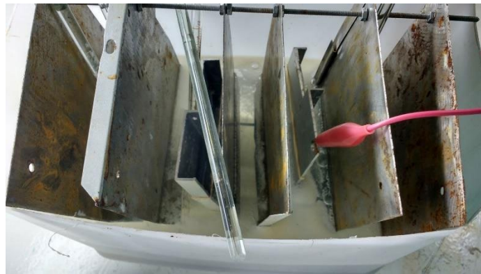
Figura 5. Configuración de Ánodo Al//Cátodo Fe, foto tomada luego de 60 min.
