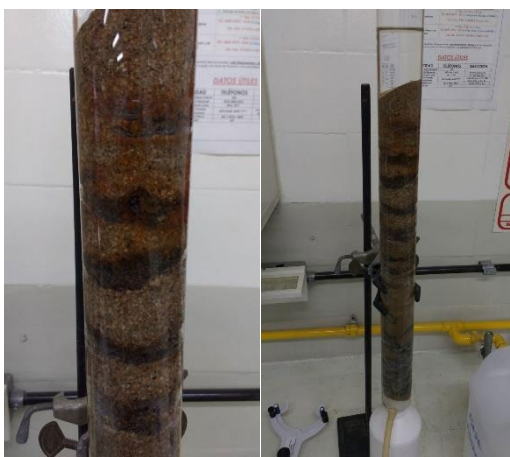
Figura 1. Filtro de Arena + Filtro Kanchan
