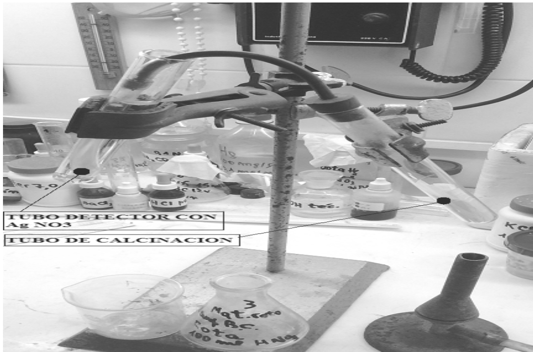
Figura 6. Calentamiento en seco del plástico y burbujeo en fase húmeda usando \text{AgNO}_3 o rojo de metilo para detectar cloruros y ácido clorhídrico respectivamente
