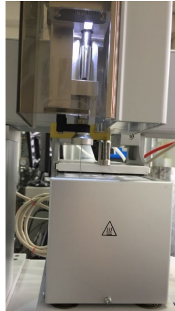
Figura 3. Extracción de muestra en horno con agitación en automuestreador Thermo Scientific Triplus RSH.
