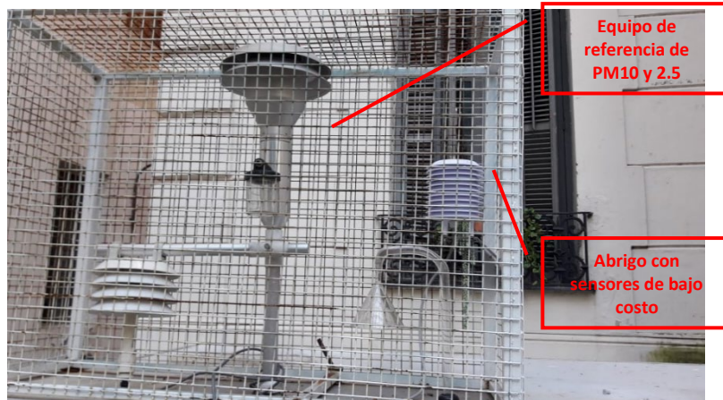
Figura 11. Evaluación de sensores de bajo costo vs referencia
