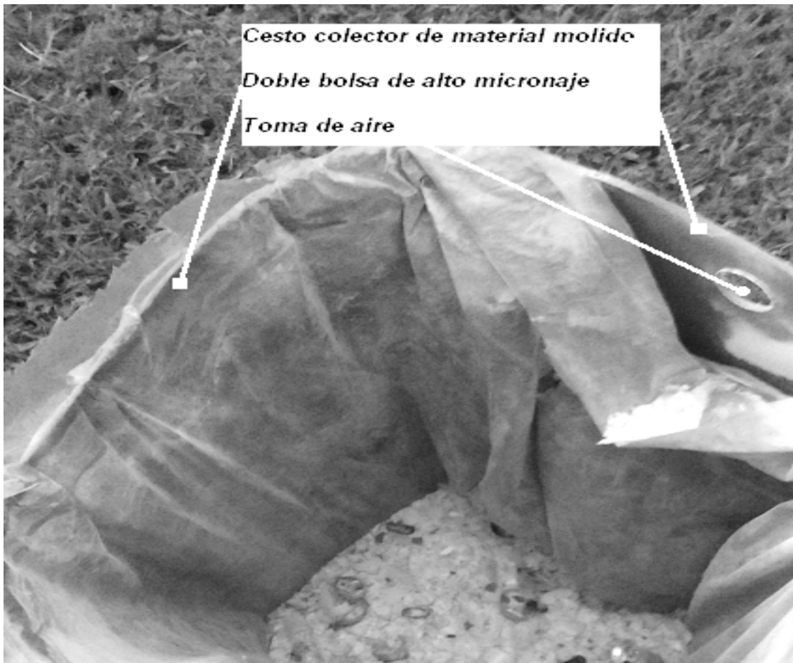
Figura 4. Se muestra el material molido obtenido de triturar 36 tubos de 1,2 m de longitud y 40 W
