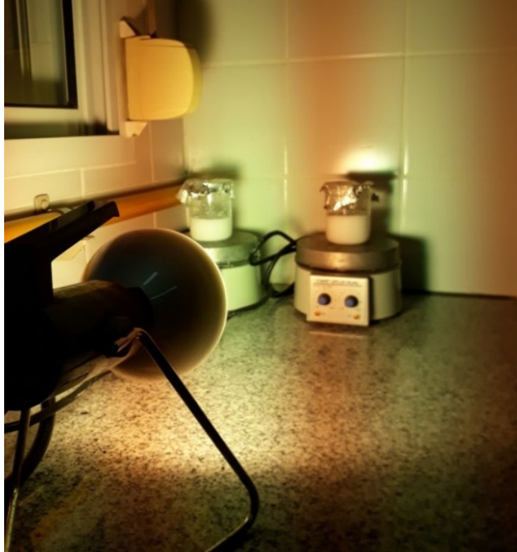
Figura 2. Disposición de la solución de TiO_2 frente a la lámpara UV
