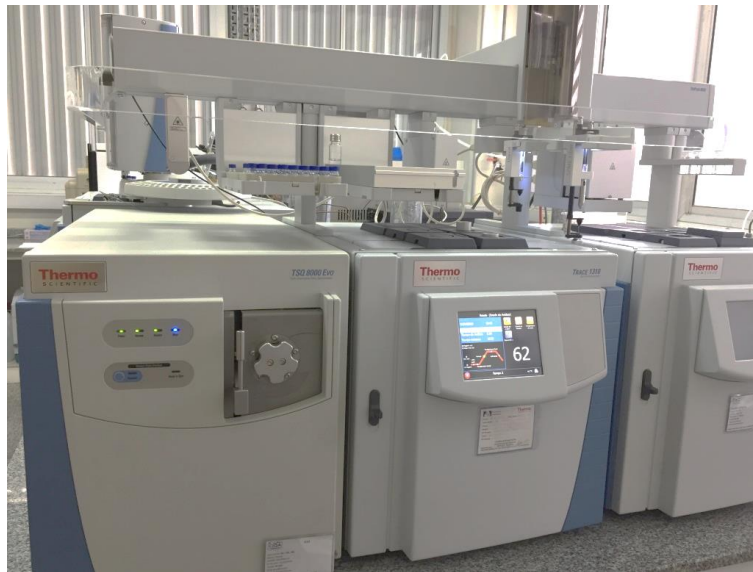
Figura 6. Cromatógrafo GC-MS/MS. Thermo Scientific TSQ8000EVO
