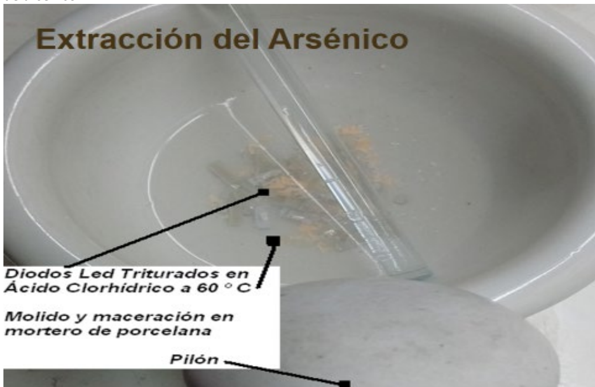
Figura 8. Extracción de arsénico en diodos led triturados usando ácido clorhídrico caliente
