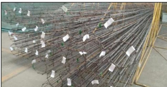
Foto 1.15 - Armadura pasiva lista para colocar en moldes.
