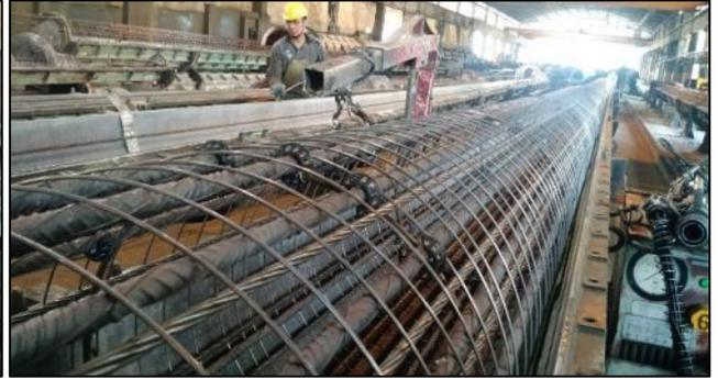
*Foto 1.18 - Moldes metálicos con armadura.*
