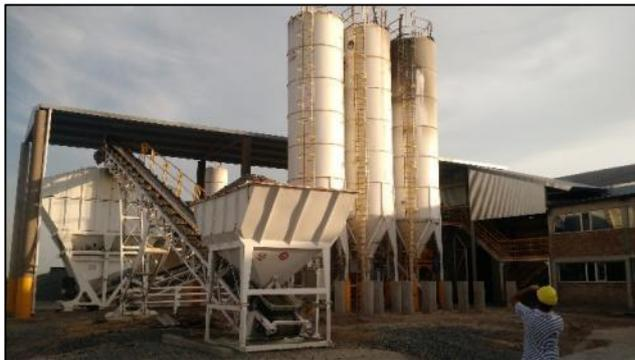
*Foto 1.23 - Tolva, cinta transportadora, silos con cemento*
