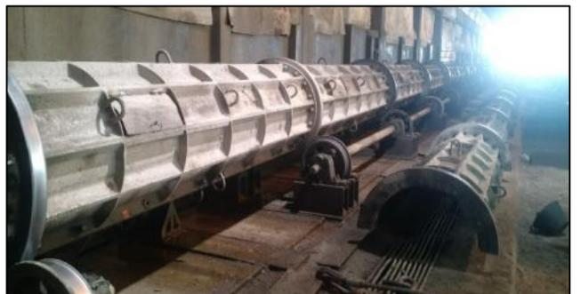
*Foto 1.26 - Moldes de postes sobre centrifugadora*
