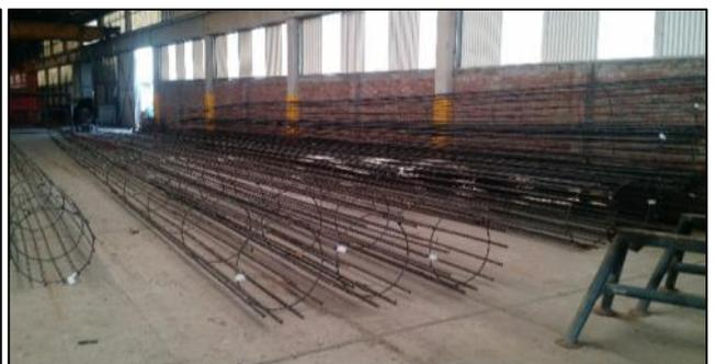
Foto 1.16 - Armadura pasiva lista para colocar en moldes
