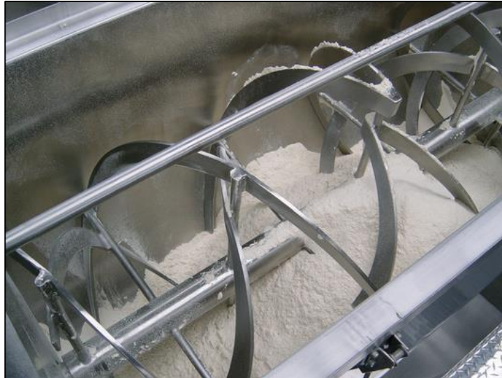
Fig. 5.38: Interior del mezclador de sólidos con doble tornillo.
