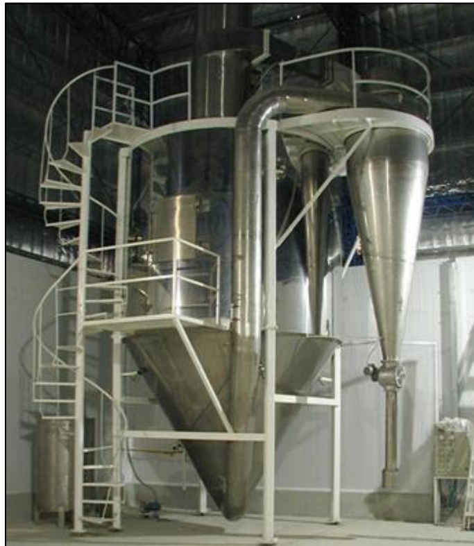
Fig. 9.114: Secador spray, modelo 3530.
