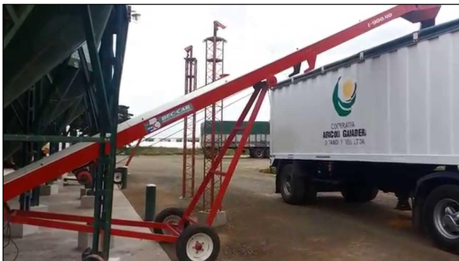
Fig. 5.4: Elevadora de tornillo sin fin realizando la carga de un camión de transporte de granos.
