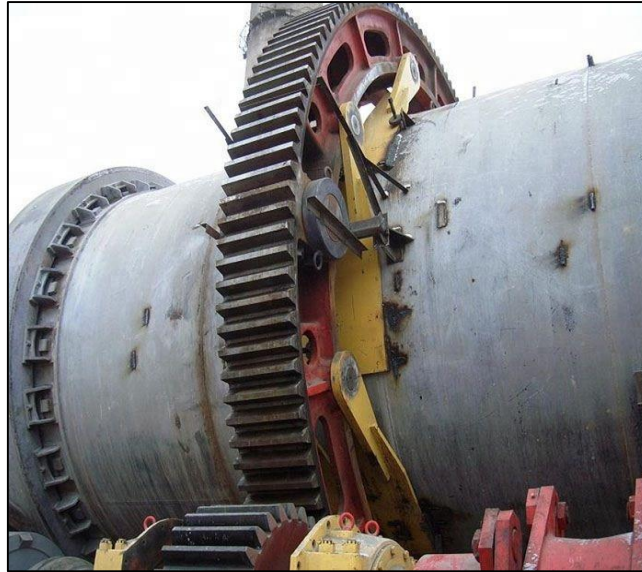
Fig. 9.42: Conjunto corona-piñón de un tambor de horno rotativo.
