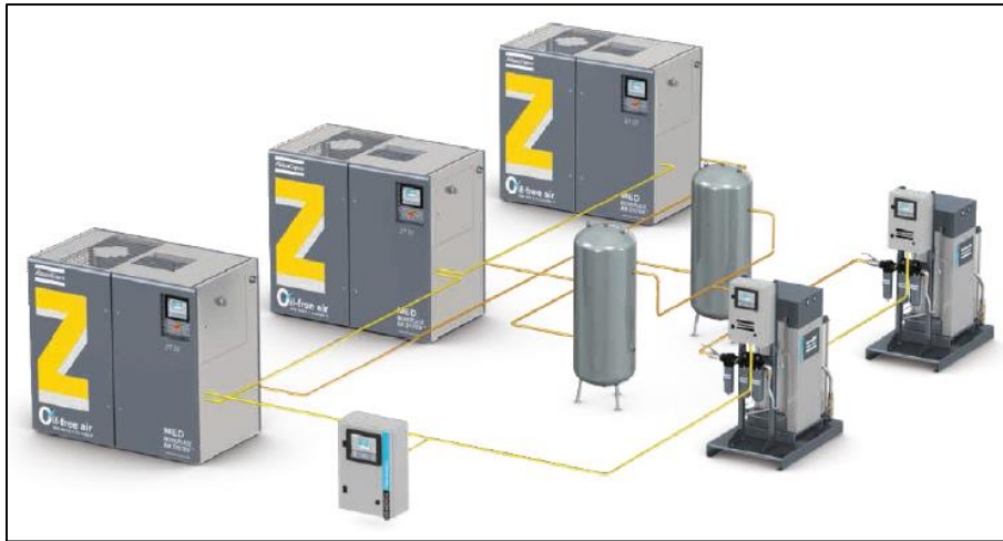
Fig. 6.6: Sistema para suministro de aire purificado.
