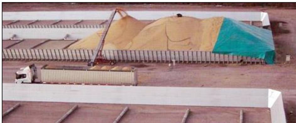
Fig. 5.5: Descarga de camión cerealero en silo australiano mediante elevadora de tornillo.
