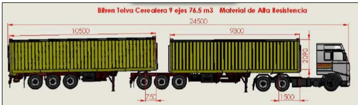
Fig. 9.1: Dimensiones típicas de un camión bitren con tolva cerealera.
