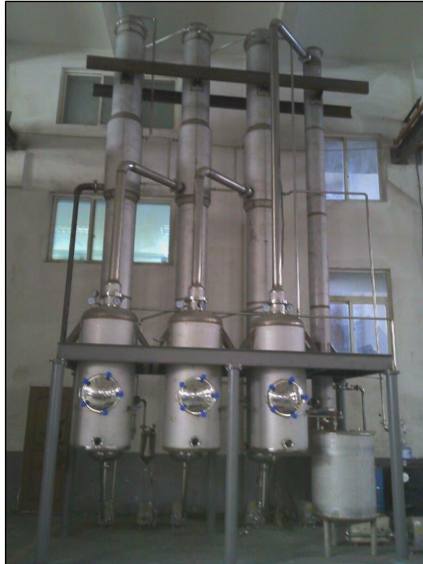
Fig. 5.18: Evaporador tubular de película descendente triple efecto.
