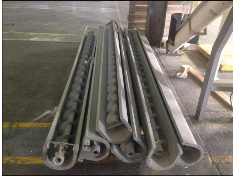
Fig. 9.12: Piezas de ensamble de bateas de tornillo helicoidal.
