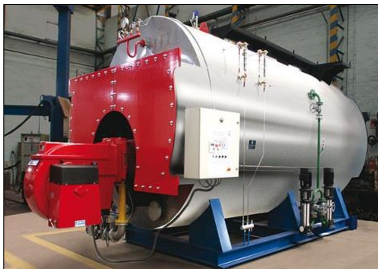
Fig. 6.1: Caldera industrial generadora de vapor.
