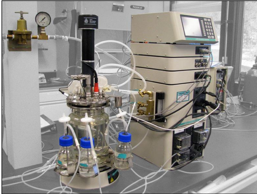
Fig. 5.23: Biorreactor de laboratorio con equipo de control automático.
