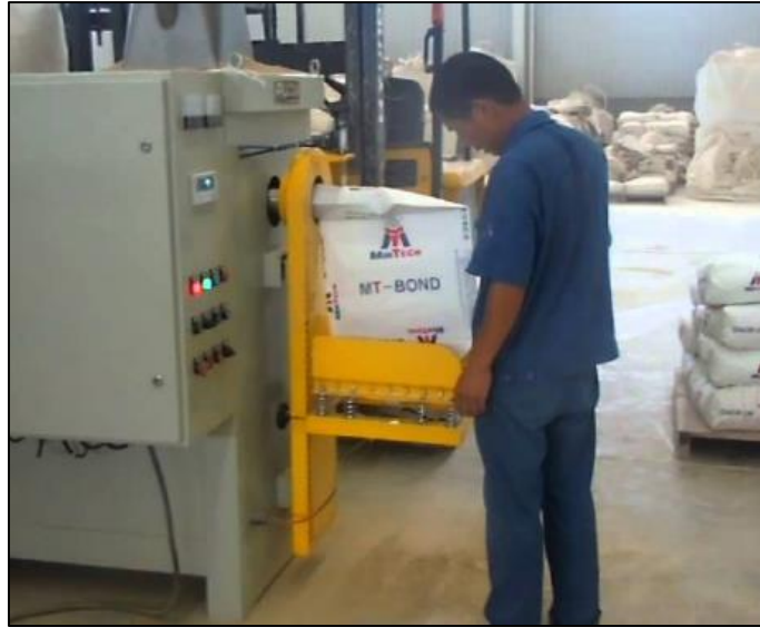
Fig. 5.39: Proceso de embolsado semiautomático.
