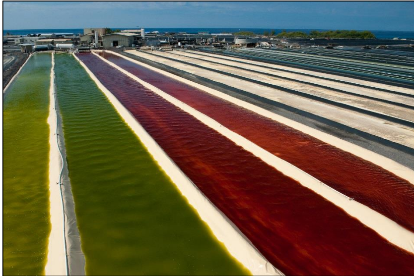
Fig. 16.4: Piletas de circulación forzadas para el crecimiento del microalga H. pluvialis .
