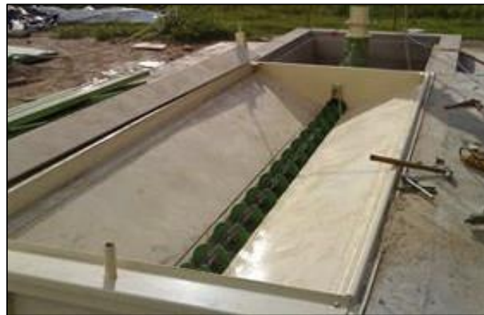
Fig. 5.6: Fondo inclinado con tornillo transportador.
