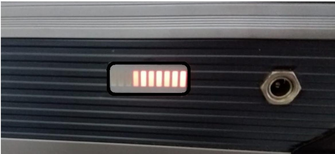
El lateral del maletín posee el conector del cargador de batería del equipo. Este se podrá utilizar enchufado mientras se carga la batería o solo modo a batería.
