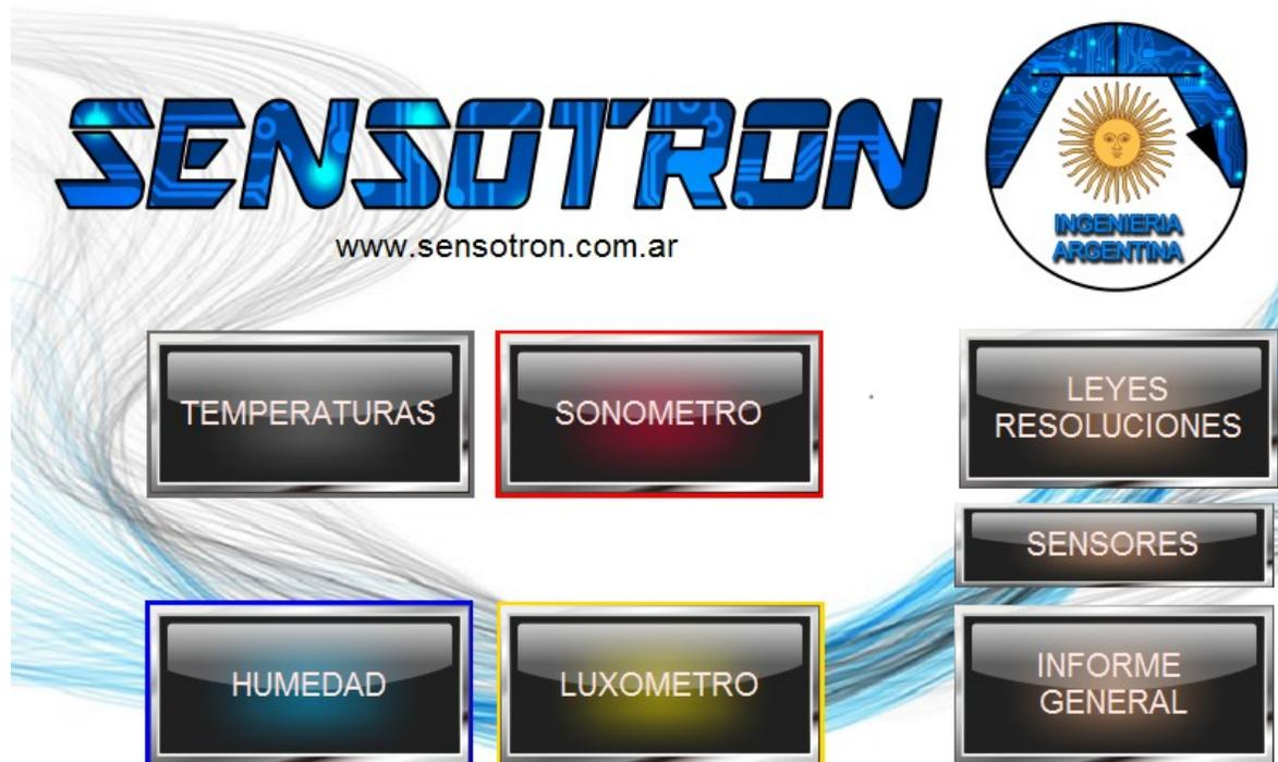
En esta pantalla el usuario podrá seleccionar cual sensor desea interrogar. Este equipo permite relevar tres sensores de temperatura, un sonómetro, un sensor de humedad y un luxómetro.
