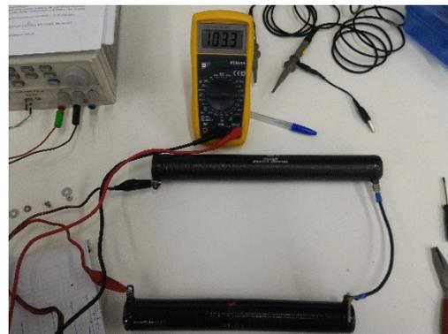
Fig.5 Resistencias de carga para el ensayo
