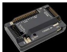
Fig.5: controladora de vuelo APM 2.5
