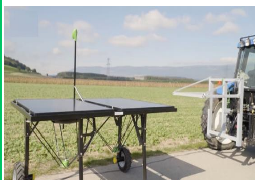
Figura 38. Paneles solares en la parte superior.
