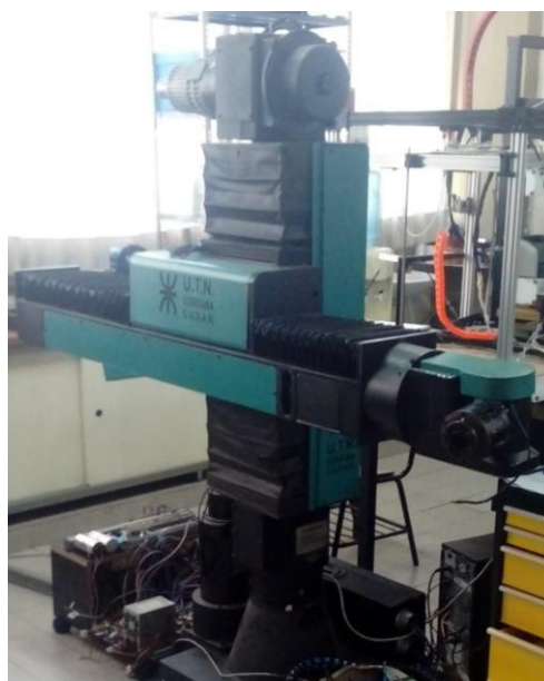
Fig. 1 - Robot ACMA, estructura mecánica disponible
