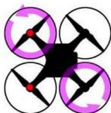
Fig.1: estructura de un cuadcóptero.
