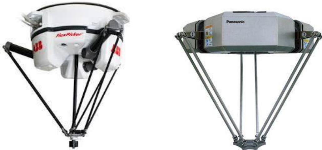
Figura1. Dos modelos de robot delta que son muy usados en la industria del procesado y empaquetado de alimentos.
