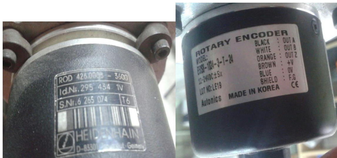
Fig. 2 - Encoders incrementales. a) 3600 pulsos por vuelta, b) 1024 pulsos por vuelta.
