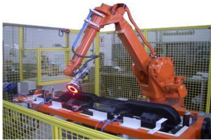
Figura 26. Inspección de piezas.
