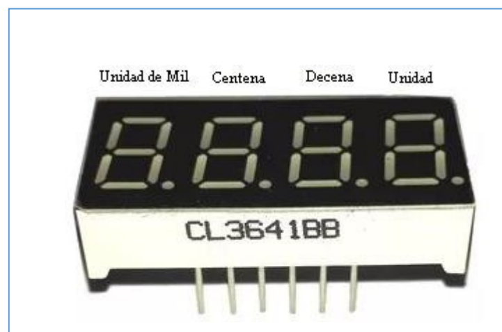
Figura 2: Display de 7 segmentos para mostrar la medición.
