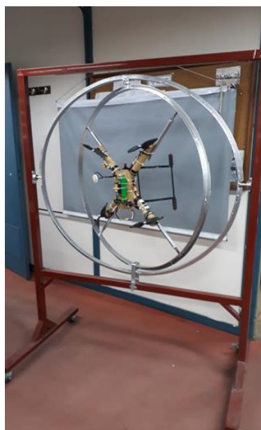
Fig.12: Banco de Ensayos. Giróscopo
