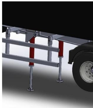
Figura 1. 5. Cilindros de elevación del chasis en posición vertical
