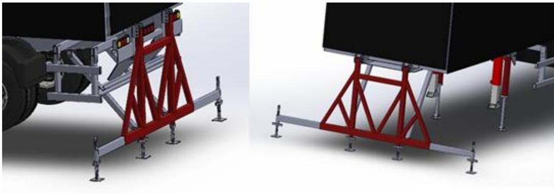
Figura 1. 8. Estructura de soporte con refuerzos diagonales y bases regulables
