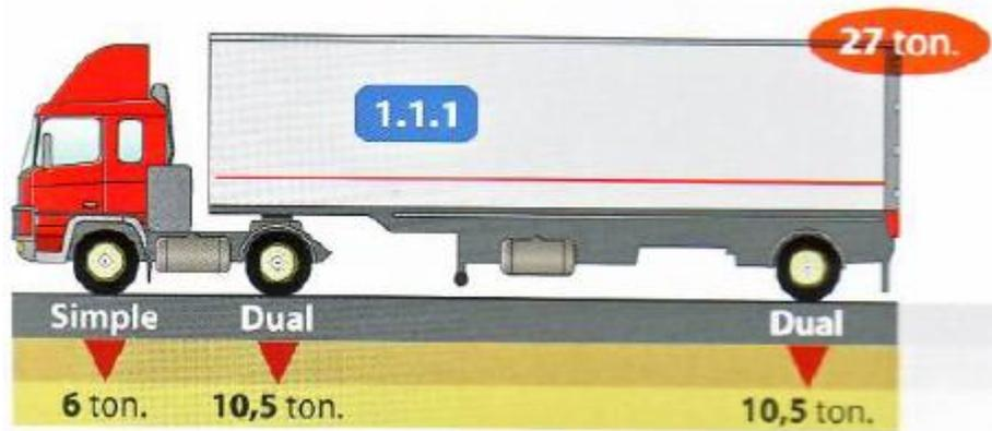
Figura 7. 2. Cargas máximas por eje
