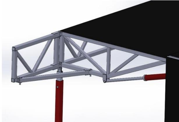
Figura 1. 14. Alas reticuladas para el volado del sonido
