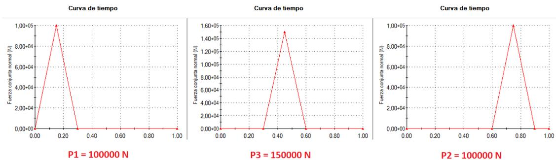
**Figura 8. 19. Secuencia de aplicación de las cargas**
