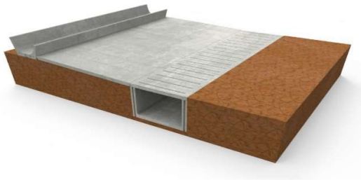
Figura N°2: Piso de hormigón armado de alta resistencia para Feedlot. Soporta agentes nocivos, permite la limpieza del piso con facilidad y el escurrimiento de los desechos hacia el piso ranurado, y el arrastre de sólidos y líquidos a un canal debajo de la superficie.
