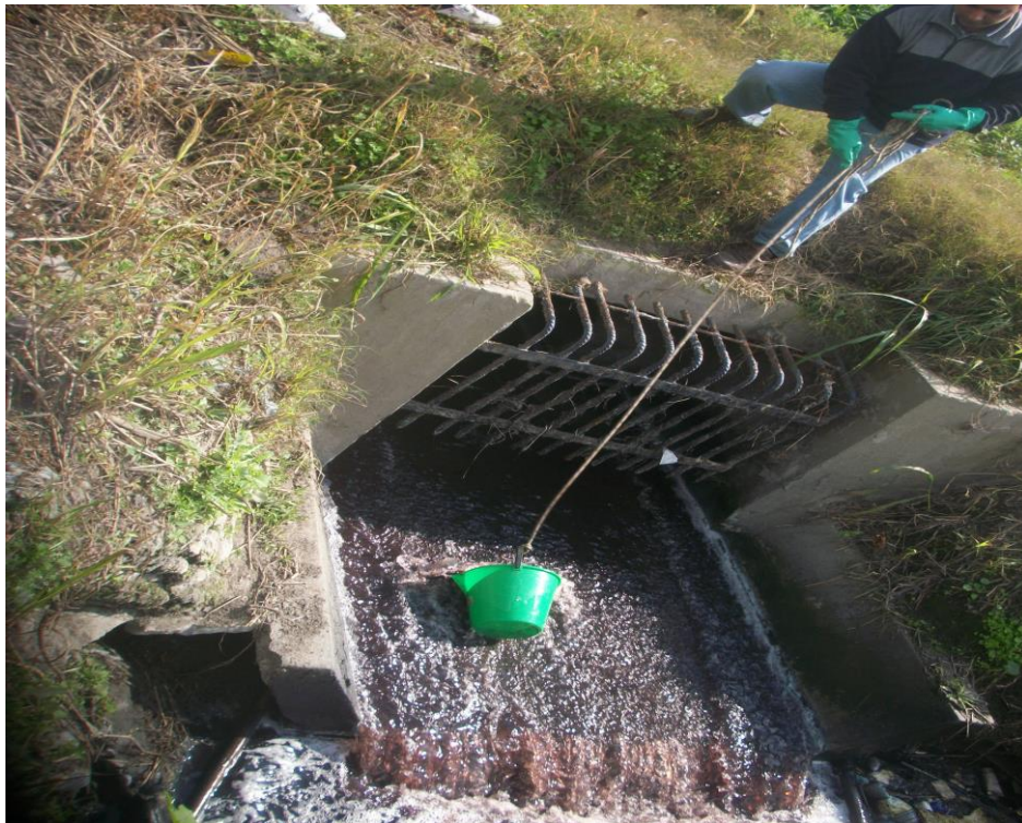
Toma de muestra en canales con alcantarillas
