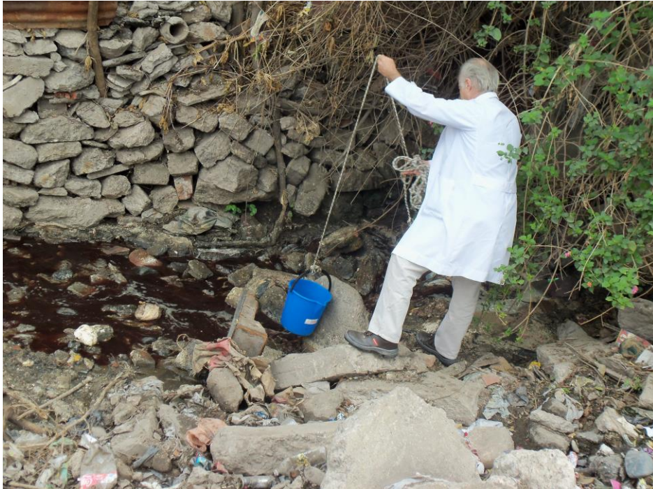
Toma de muestra de líquido industrial en canal pedregoso
