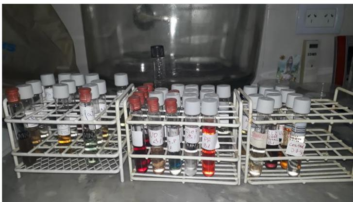
Figura 8- Preparacion de tubos de muestras para fotómetro.
