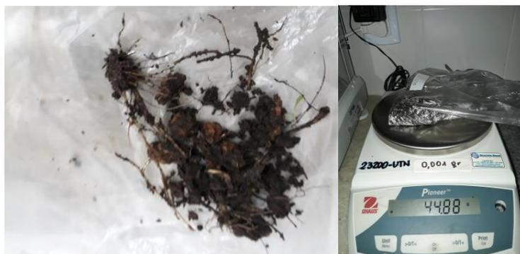
Figura 12– Limpieza de la muestra y pesaje.
