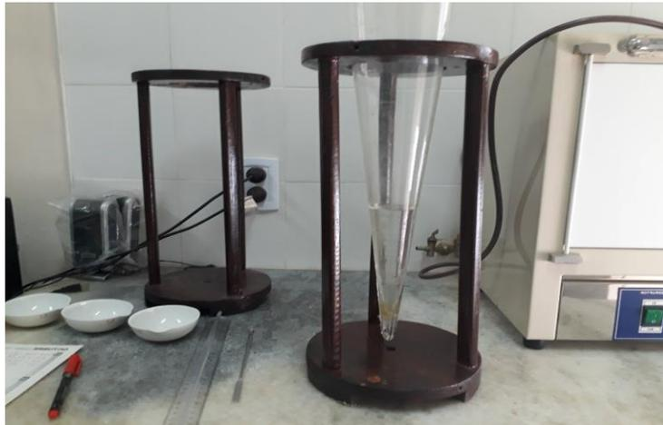
Figura 9 – Decantación para medición de sólidos.
