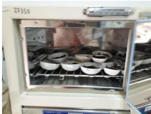
Figura 13- Colocación de muestras de suelo en estufa.
