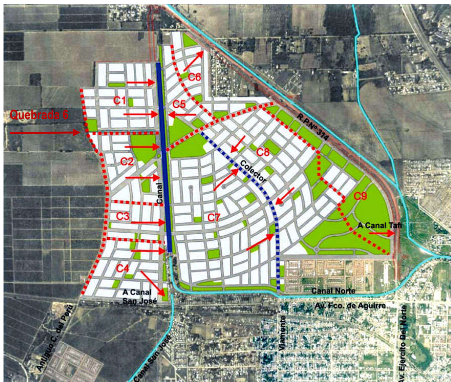
Figura N° 19: Sistema de drenaje pluvial de la urbanización Lomas de Tafi. Extraído del proyecto de la urbanización.
