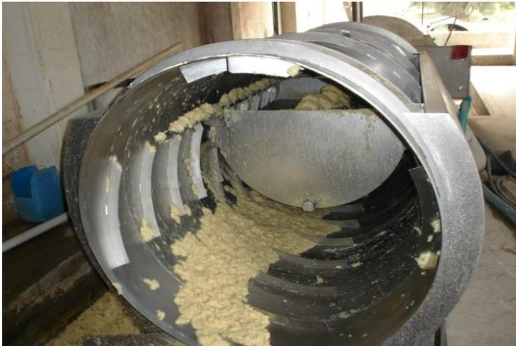
**Foto 12: Tamiz separando pulpa de lenta degradación. Gentileza Citromax.**
