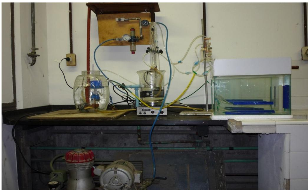
**Foto 15: Vista del compresor y del sistema de regulación de la presión del aire.**
