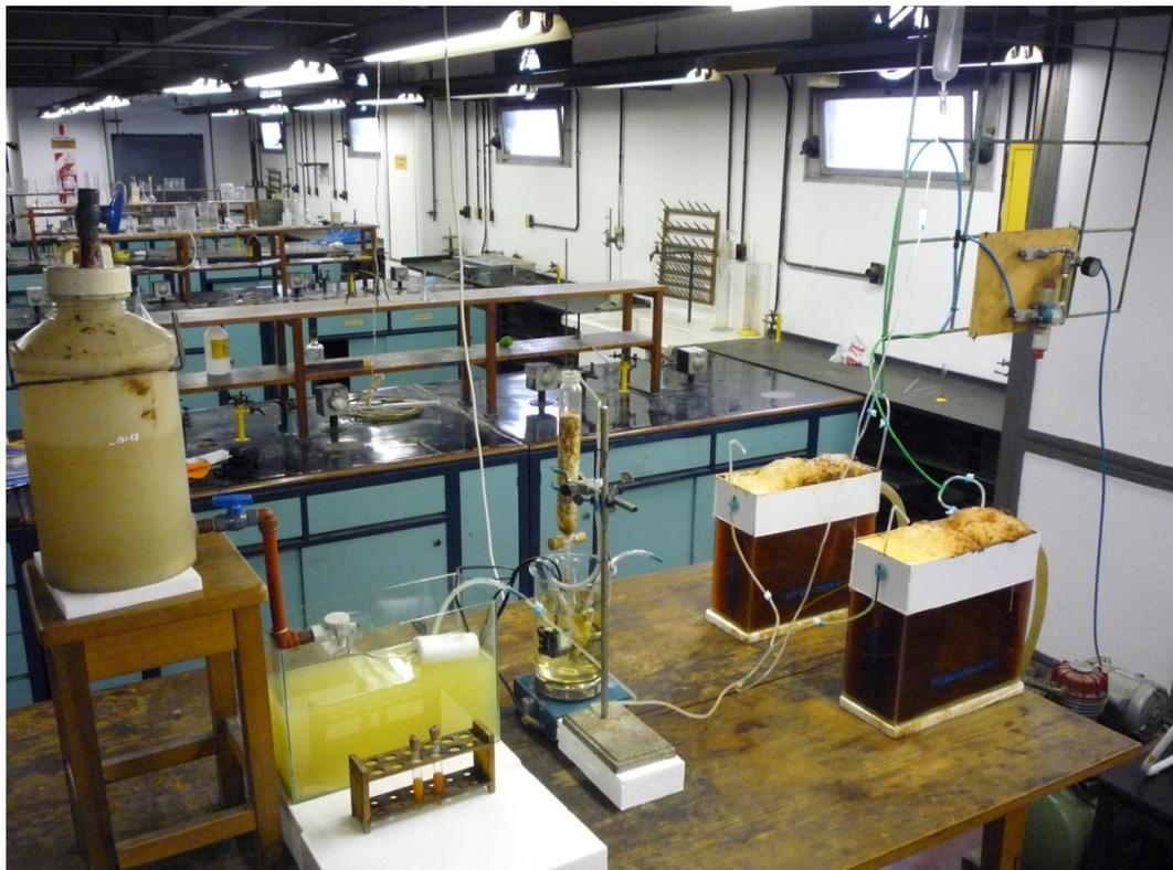
**Foto 23: Sistema operando y con visualización del cambio de color en el proceso de enclado y de la formación de espuma en los reactores. Laboratorio QGeI.**
