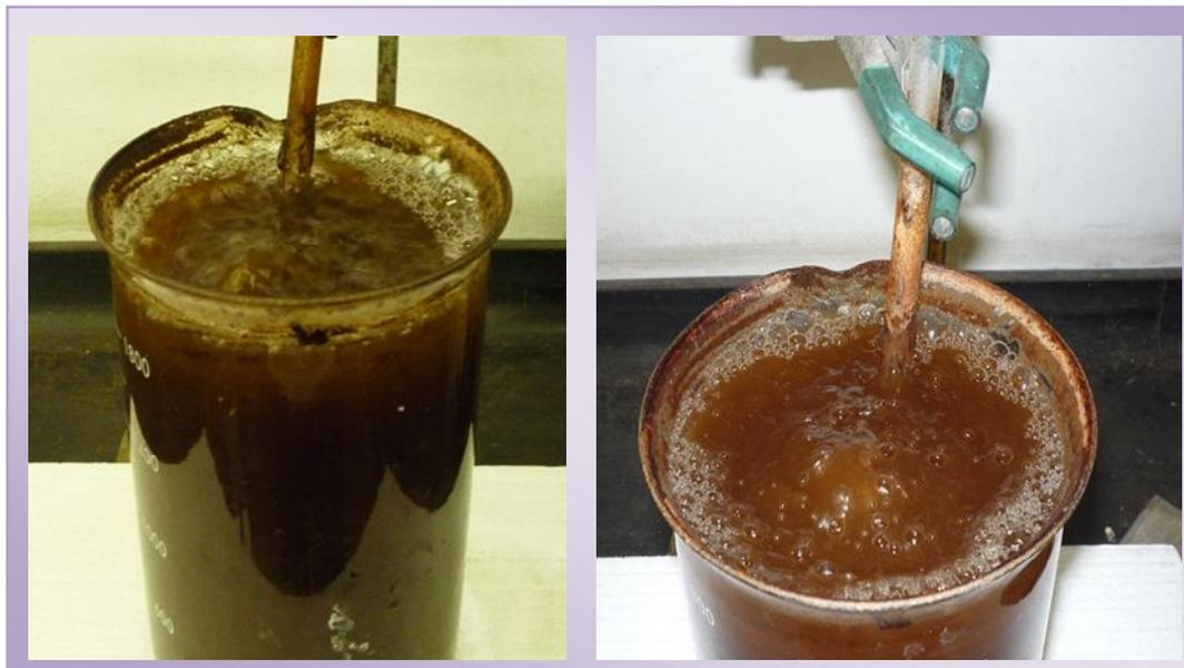
**Foto 17: Mezcla inicial de efluente con cloacales con burbujeo, el avance del proceso de aclimatación se nota por la variación de la coloración. Laboratorio QGeI.**
