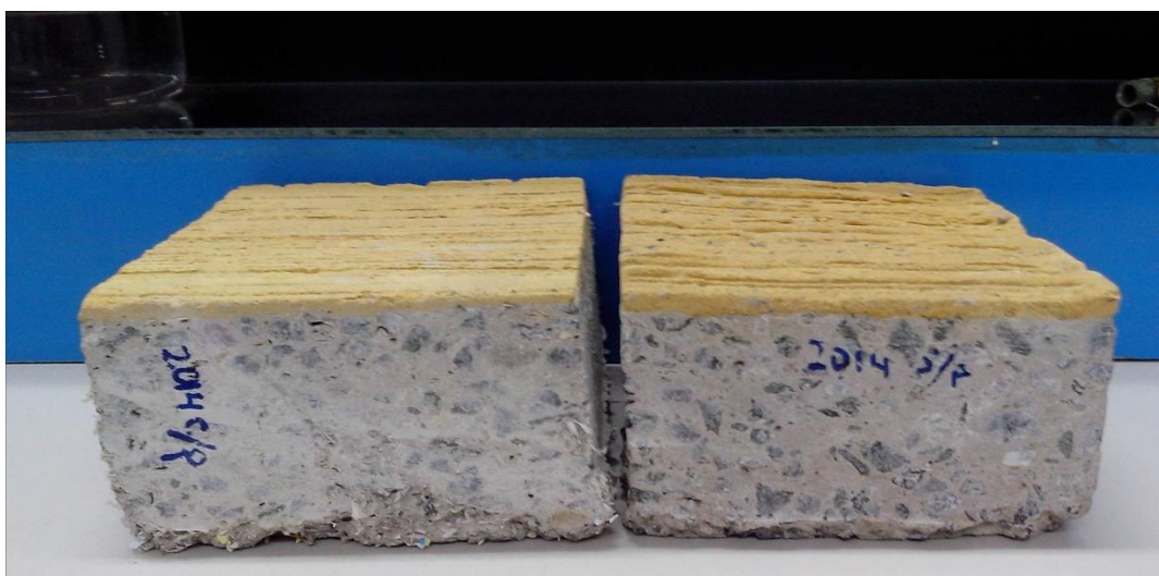
Figura N° V.1. Corte de la loseta, los puntos blancos, en la loseta izquierda, son el copolímero agregado.
