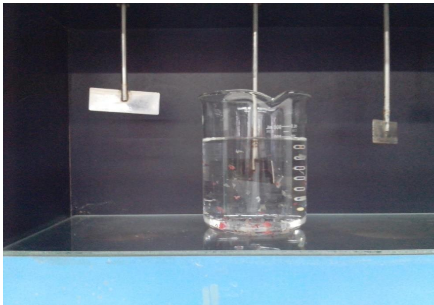
Figura N° IV.2. Lixiviado de loseta agitándose en el Jartex
