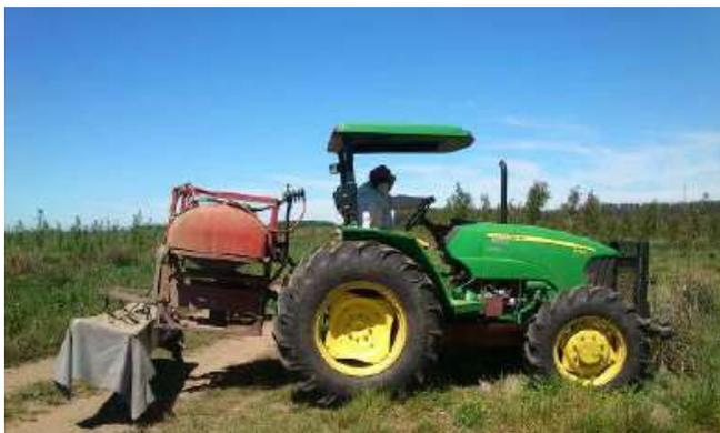
**Figura 26.** Tractor con enganche de 3 puntos.
